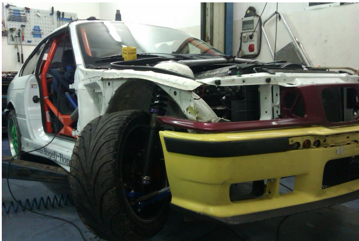
Slika 95 Kut od 60 stupnjeva zakreta prednjih kotača
