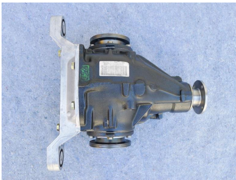
Slika 54 Samoblokirajući diferencijal u kućištu 210
