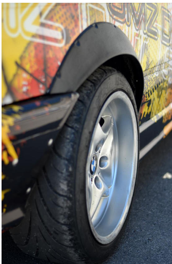
Slika 58 Stražnji pneumatici u dimenziji 245/40 ZR17
