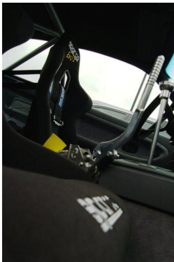
Slika 57 Ugrađena ručna kočnica
