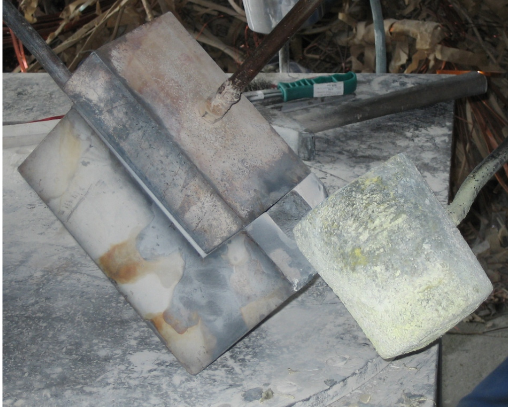
Slika 9. Lijevanje u kokilu
