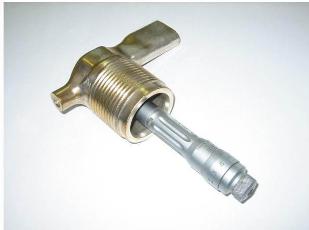
Slika 16. Primjer dimenzionalnog ispitivanja slijepe rupe
