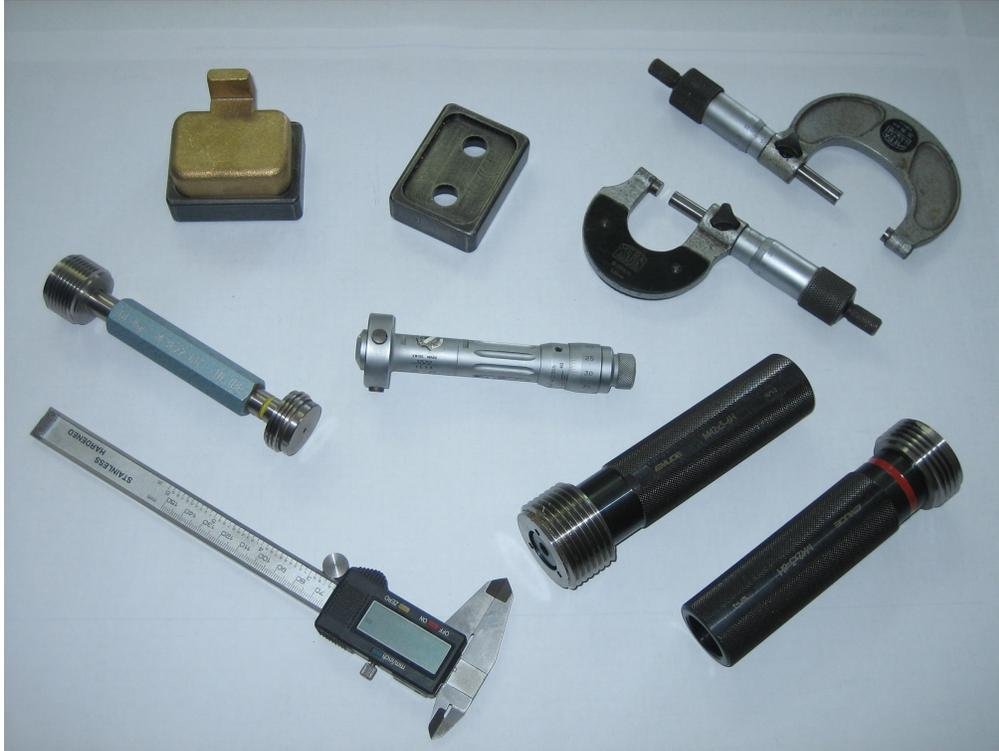
Slika 14. Ručna mjerila za dimenzionalno ispitivanje
