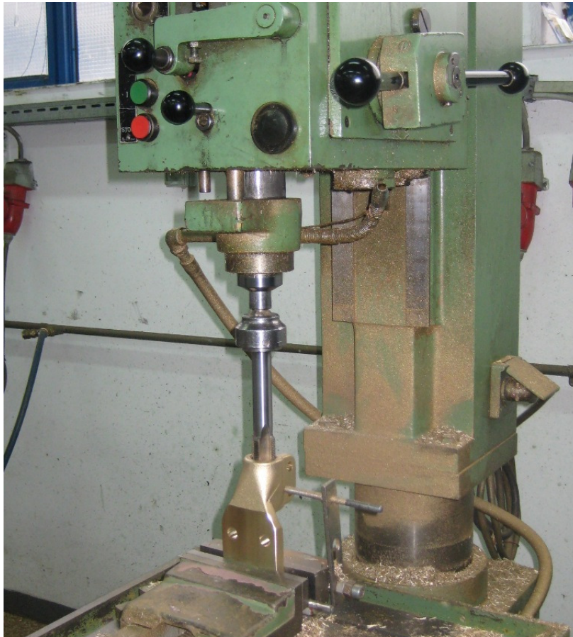
Slika 36. Urezivanje navoja M30x2
