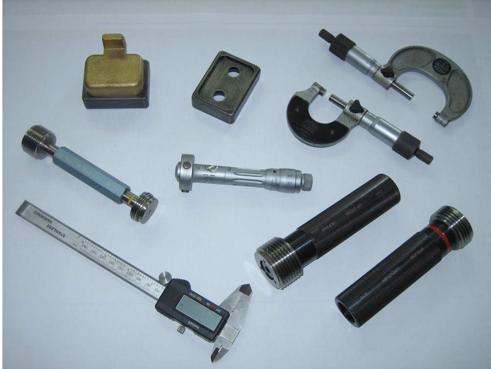
Slika 14. Ručna mjerila za dimenzionalno ispitivanje
