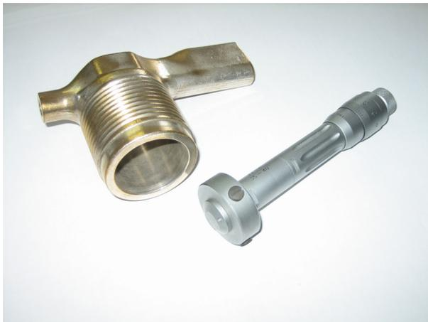
Slika 15. Trokraki mikrometar
