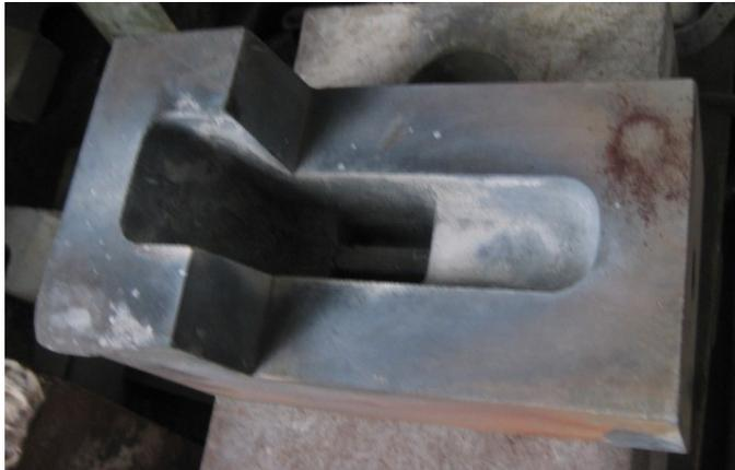
Nakon ulijevanja pričekava se nekoliko trenutaka kad se miče gornji dio kalupa. Nakon još nekoliko trenutaka kad se talina dovoljno skrutne, po procjeni ljevača, odljevak se istresa iz kalupa. Kalup se zatim uranja u vodu kako bi se ohladio na početnu radnu temperaturu što omogućuje i slijedećoj talini da se što brže ohladi.
