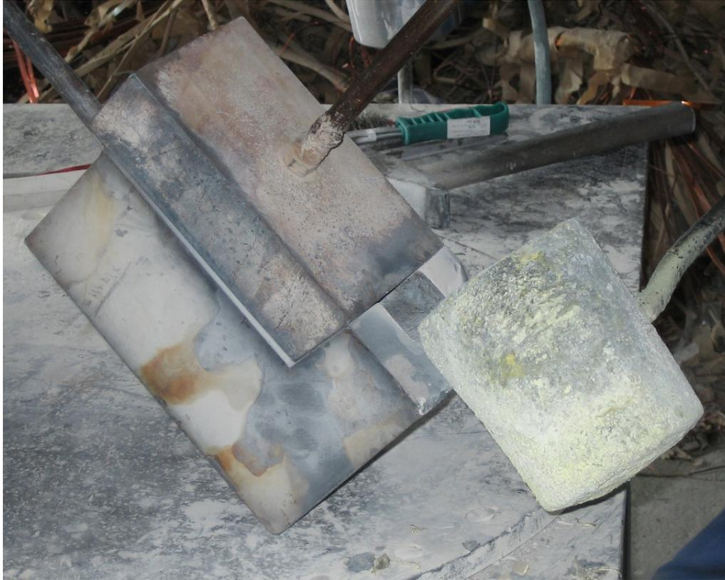
Slika 9. Lijevanje u kokilu
