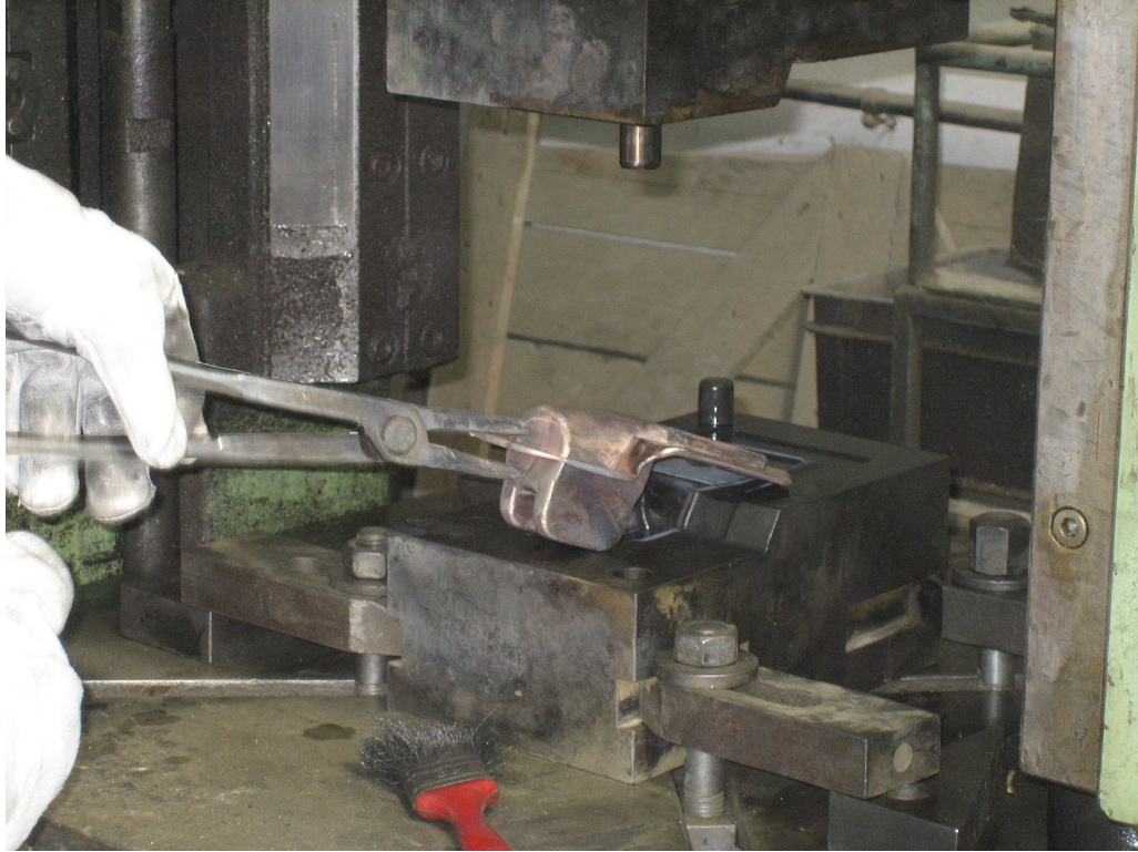
Slika 25. Vađenje otkivka iz ukovnja
