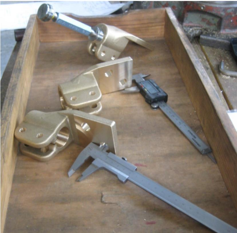
Na slici 44. su označene dimenzije čije su izmjerene vrijednosti navedene u tablici 1. Dimenzije označene brojevima od 1 do 6 u tablici 1. su mjerene pomičnim mjerilom dok je navoj M30x2- 6H kontroliran graničnim mjerilom po principu ide- neide.
