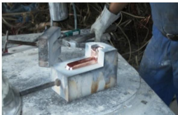
Slika 22. Odljevak u kalupu
