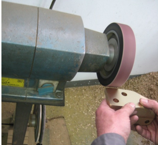
Slika 41. Brušenje bridova priključnice
