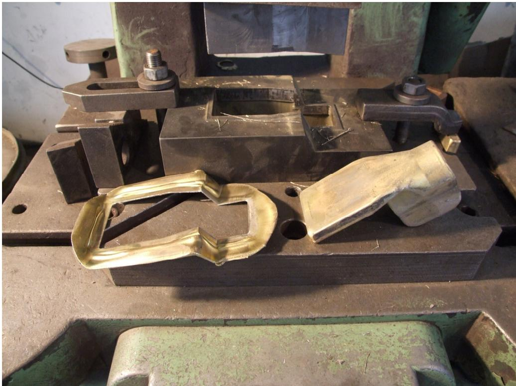
Slika 30. Obradak nakon odsjecanja
