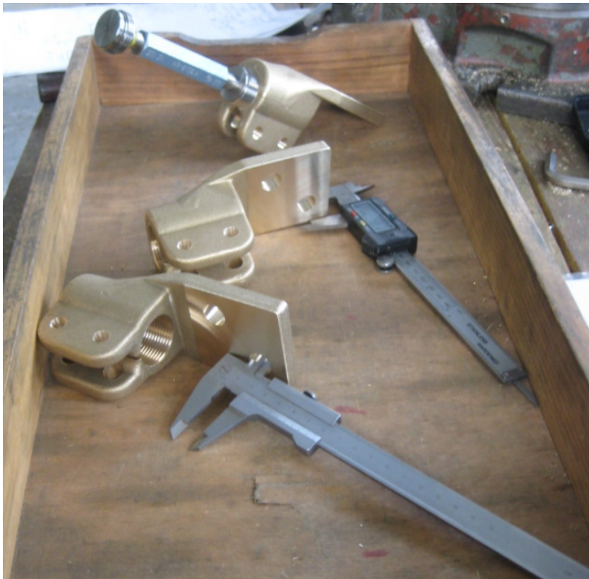
Slika 45. Ručna mjerila korištena u mjerenju dimenzija
