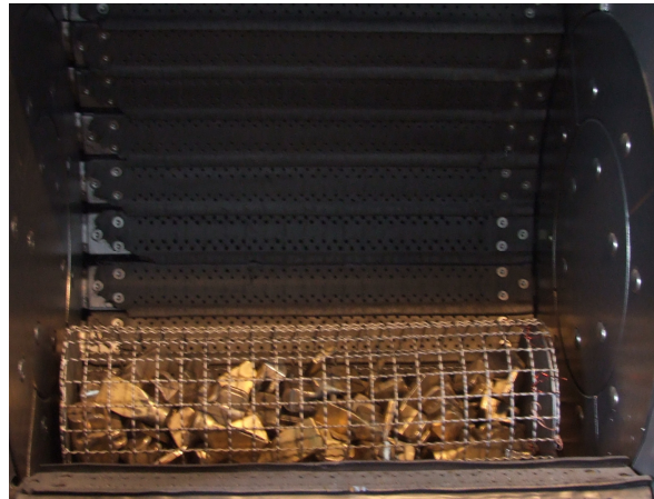
Slika 32. Priključnice u bubnju sačmarilice
