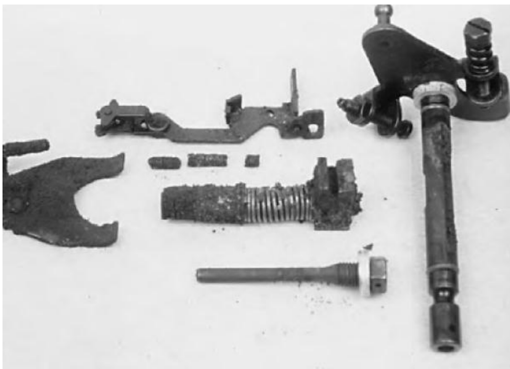
Slika 3. Elementi oštećeni zbog hrđe u vodi
