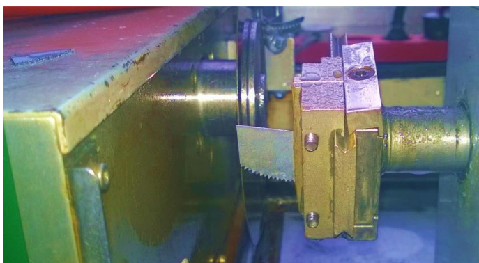
Slika 22: Prikaz postupka izrezivanja dijela uzorka pile.
