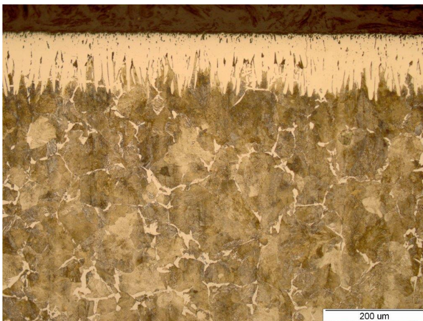
Slika 25: Mikrostruktura boridnog sloja C45, povećanje 200x
