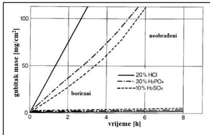
Slika 3: Korozijačka postojanost boridnih i neobrađenih čelika AISI 1045 (Ck45) pri 56 °C.
