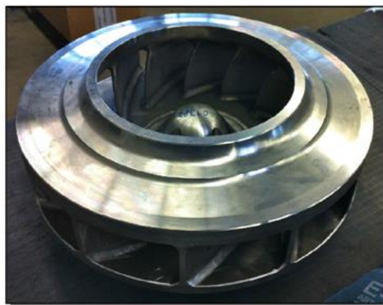
Slika 4: Borirani dio pumpe
