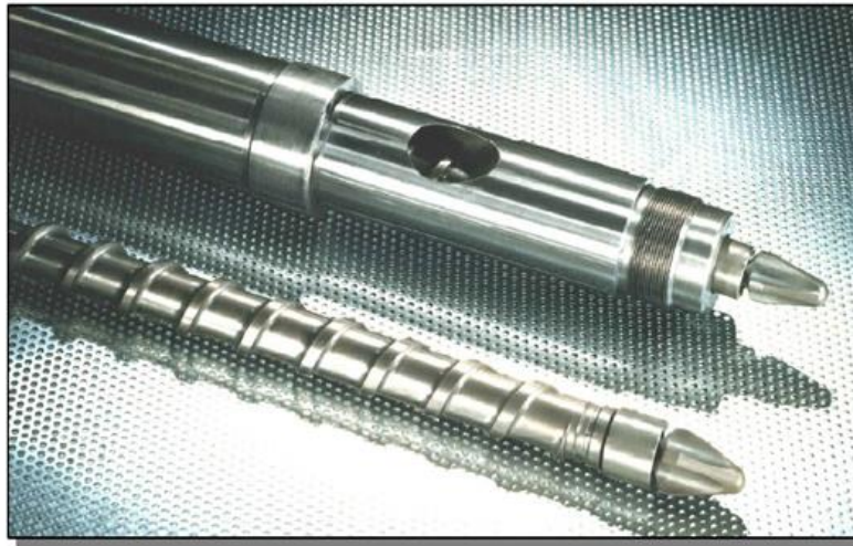
Slika 7: Borirani vijci za ekstrudiranje
