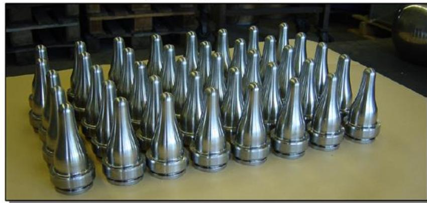
Slika 5: Borirani dijelovi za proizvodnju staklenih proizvoda
