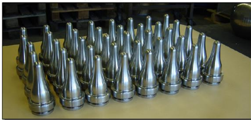
Slika 5: Borirani dijelovi za proizvodnju staklenih proizvoda
