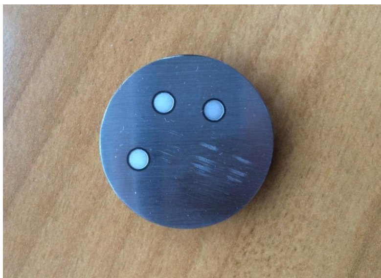
Slika 22. Uzorak nakon analize kemijskog sastava
