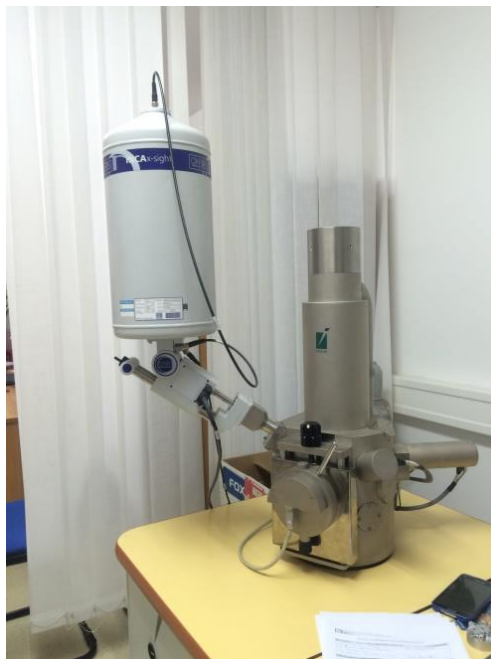
Slika 31. Skenirajući elektronski mikroskop (SEM) Tescan Vega TS5136LS
