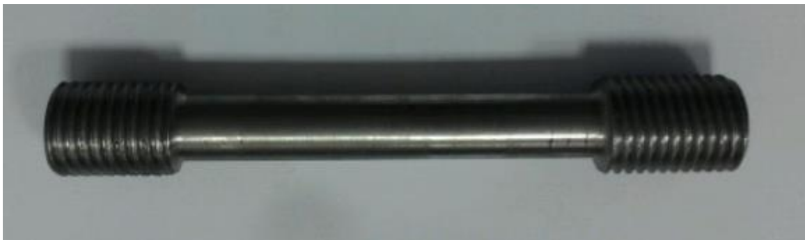
Slika 37. Epruveta za statičko vlačno ispitivanje
