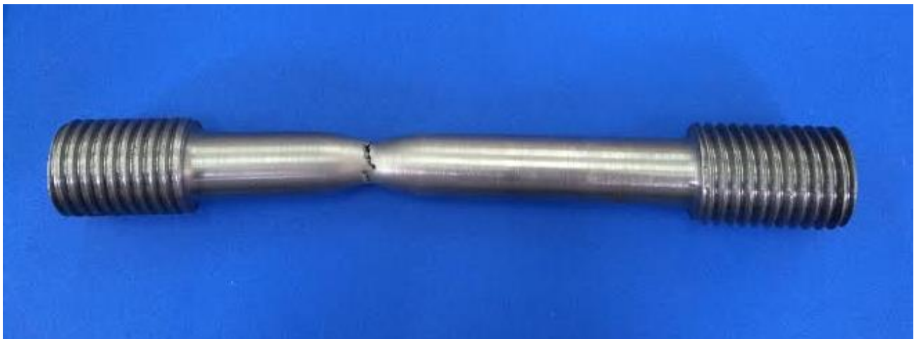
Slika 39. Epruveta nakon statičkog vlačnog ispitivanja
