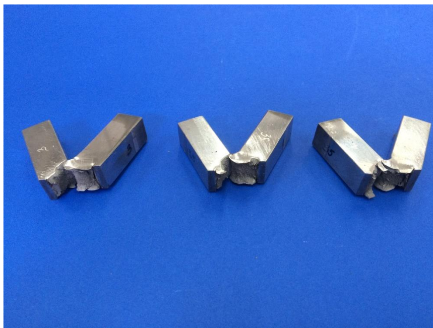
Slika 42. Epruvete nakon provedenog ispitivanja
