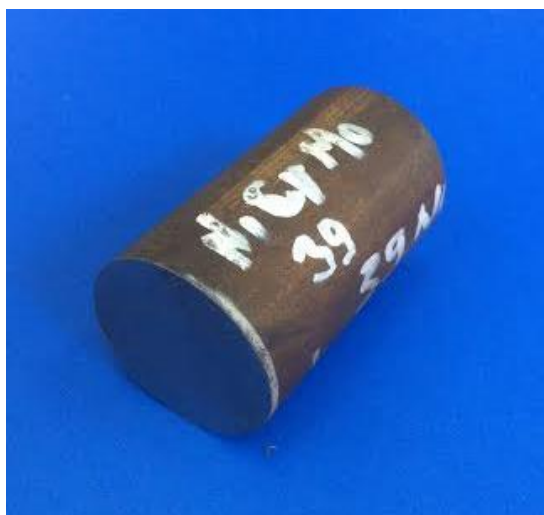
Slika 20. Dio čelične šipke iz koje su izrezani uzorci
