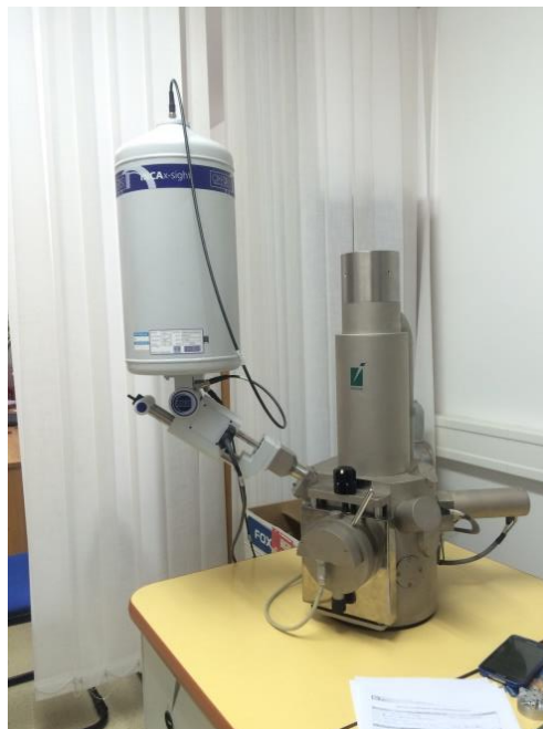
Slika 31. Skenirajući elektronski mikroskop (SEM) Tescan Vega TS5136LS
