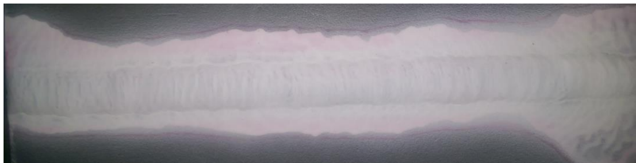
Slika 24. Ispitivanje lica zavora penetrantima - osušen razvijlač
