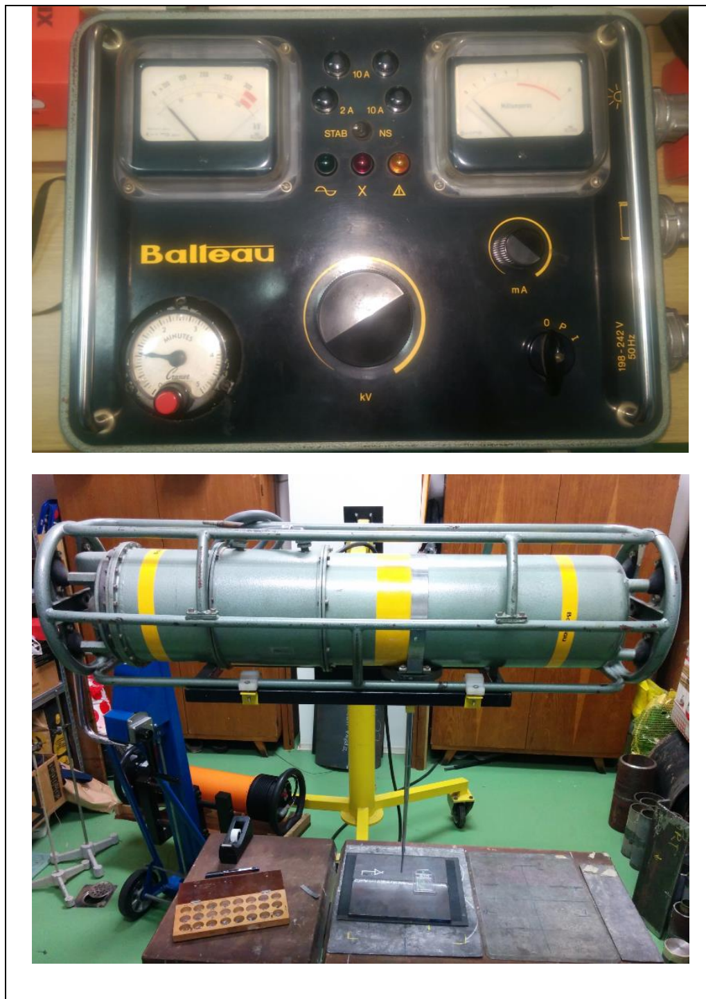
Slika 26. RTG uređaj - Balteau 300 D
