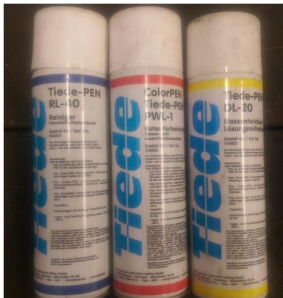
Slika 22. Korištena sredstva: čistač, penetrant, razvijlač
