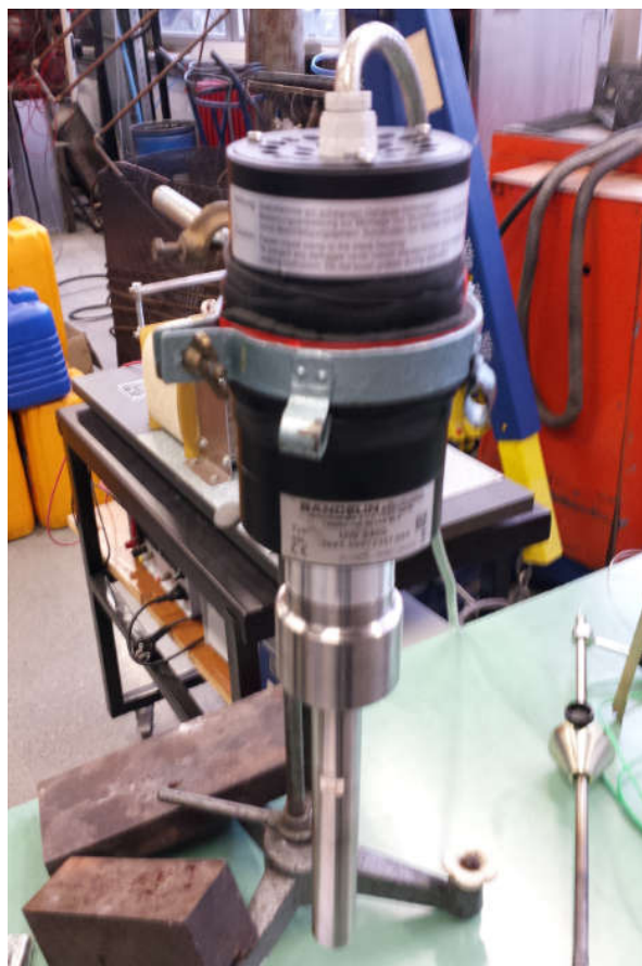
Slika 56. Uređaj za ultrazvučno miješanje – ultrazvučna sonotroda
