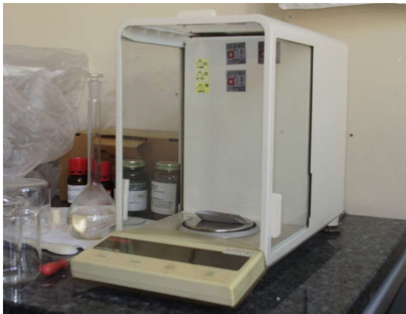
Slika 24. OHAUS Analytical Plus analitička vaga
