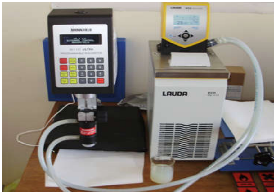
Slika 29. BROOKFIELD - ov reometar i termostatisirana kupelj
