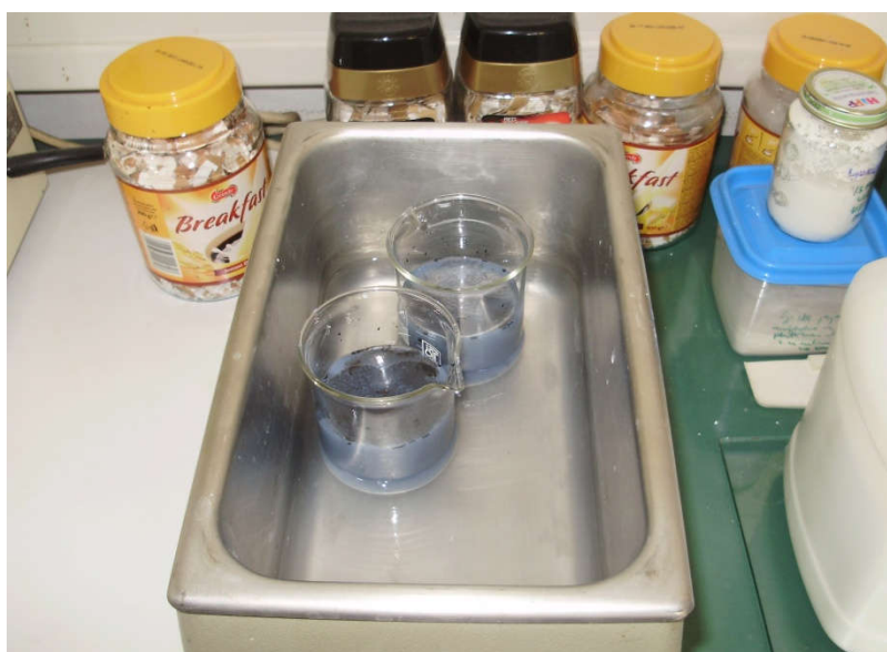
Slika 25. Homogenizacija nanofluida u ultrazvučnoj kupci BRANSONIC 220
