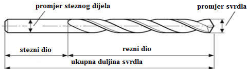
Slika 38. Spiralno svrdlo [23]
