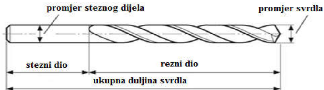
Slika 38. Spiralno svrdlo [23]
