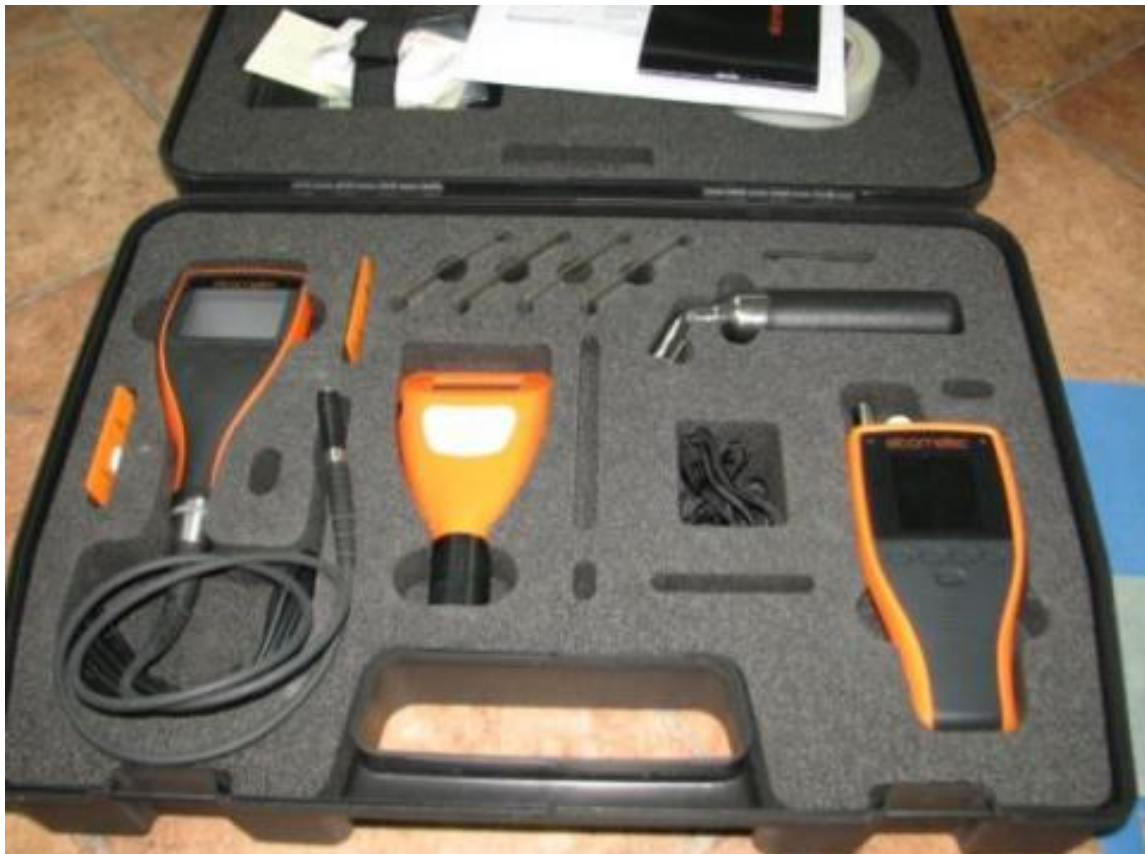
Slika 14. Uređaj „Elcometer 456“ za mjerenje debljine prevlake
