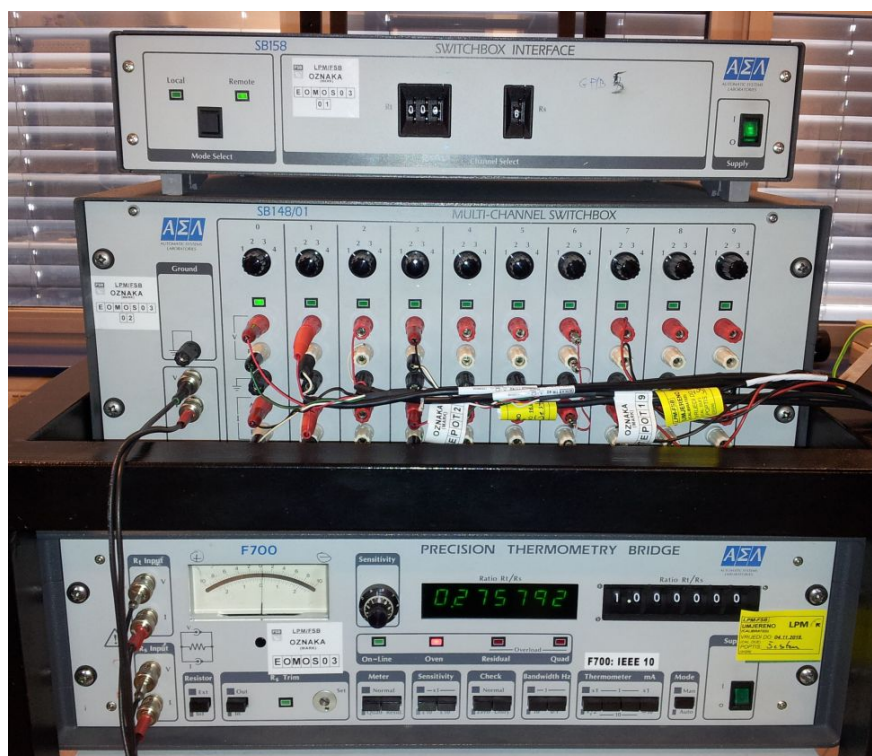
Slika 10: Otpornički most sa spojenim svim navedenim komponentama
