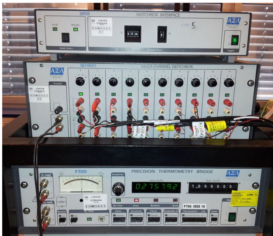
Slika 10: Otpornički most sa spojenim svim navedenim komponentama
