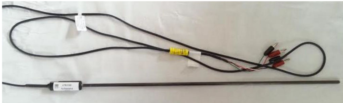
Slika 9: Termometar korišten za umjeravanje
