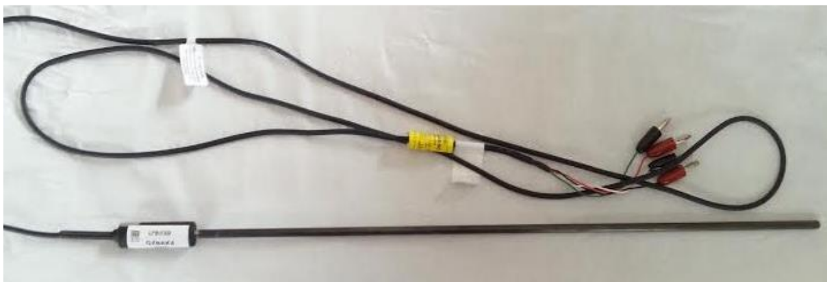
Slika 9. Termometar korišten za mjerenje temperature peći
