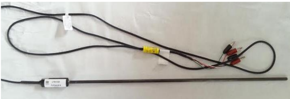
Slika 9. Termometar korišten za mjerenje temperature peći
