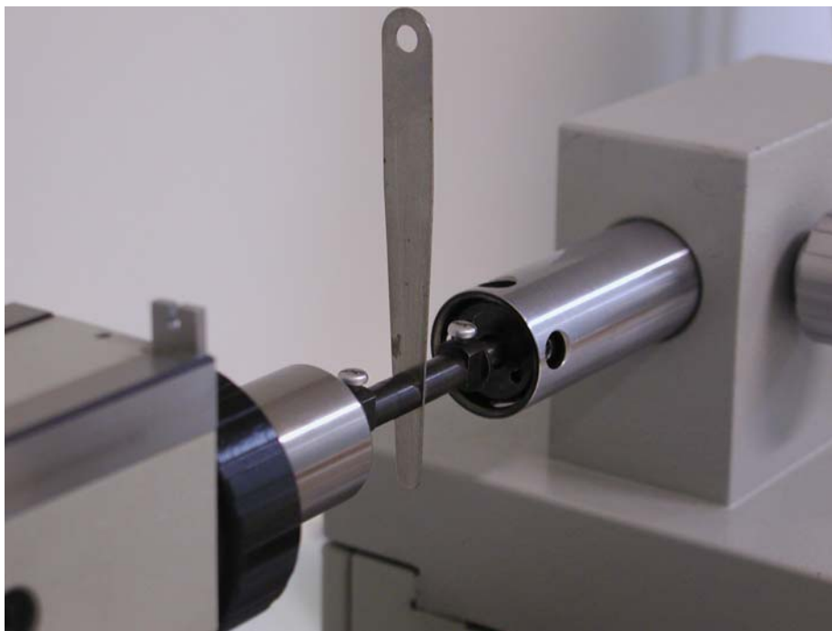
Slika 13. Prikaz mjerenja pomoću univerzalnog uređaja za mjerenje duljina
