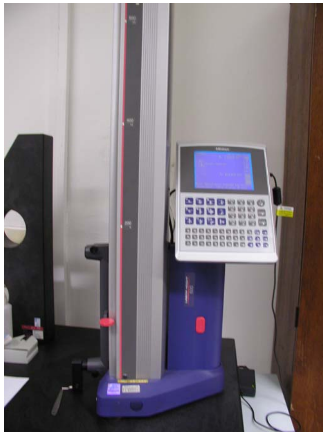
Slika 12. Prikaz mjerenja pomoću digitalnog visinomjera
