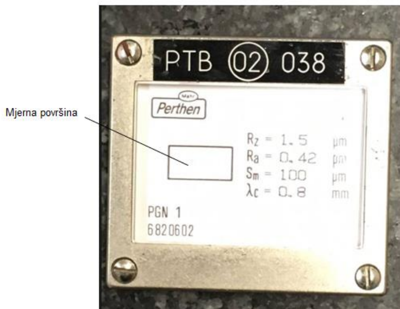
Slika 37. Referentni državni etalon za hrapavost Perthen
