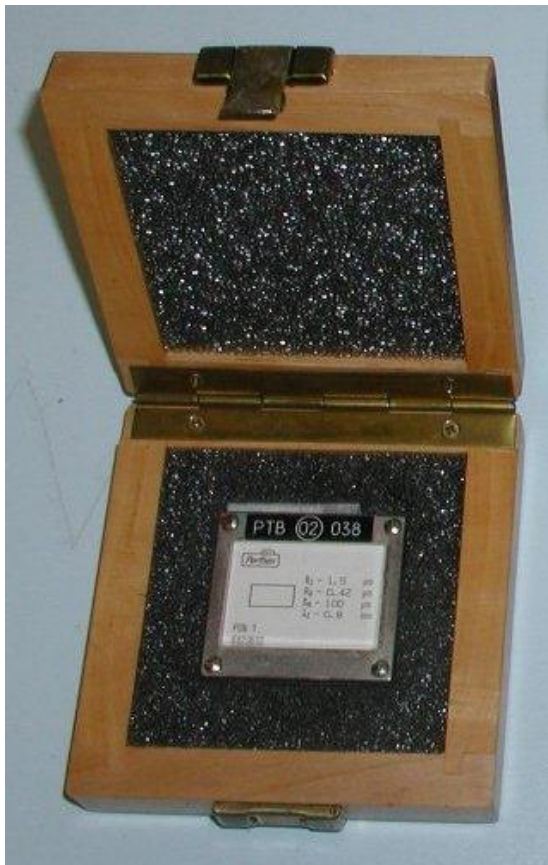
Slika 5. Etalon hrapavosti Perthen
