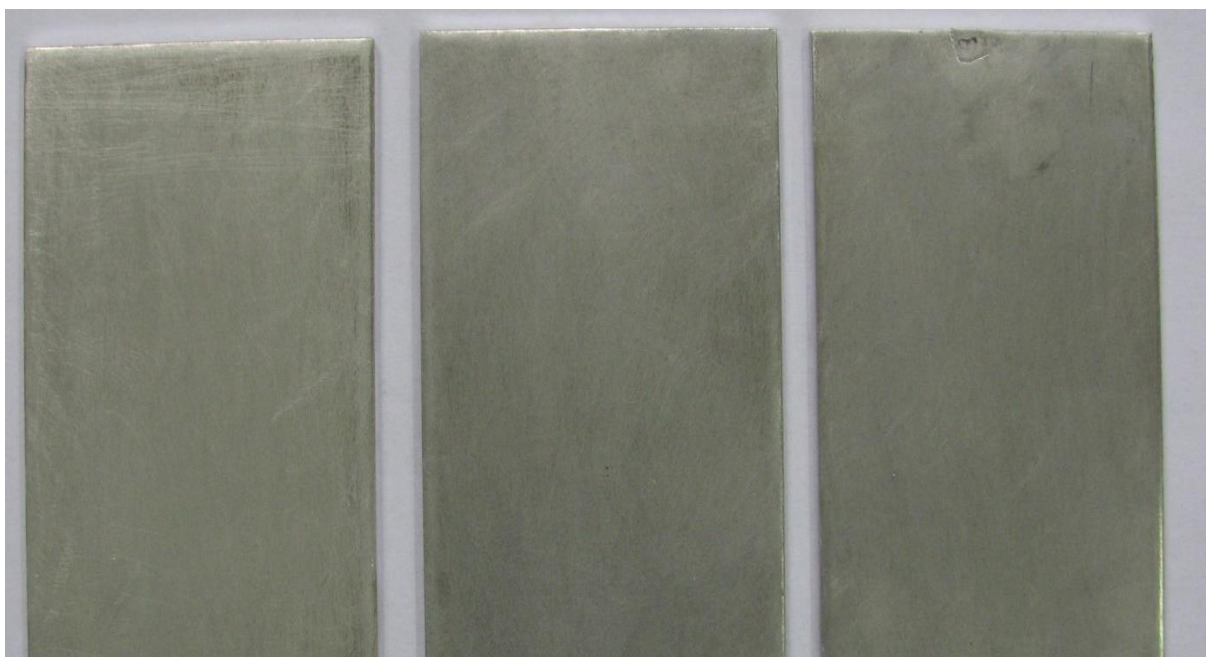
Slika 35. Rezultati ispitivanja uzoraka od aluminija PE folijom debljine 100 \mu\text{m} u vlažnoj komori
