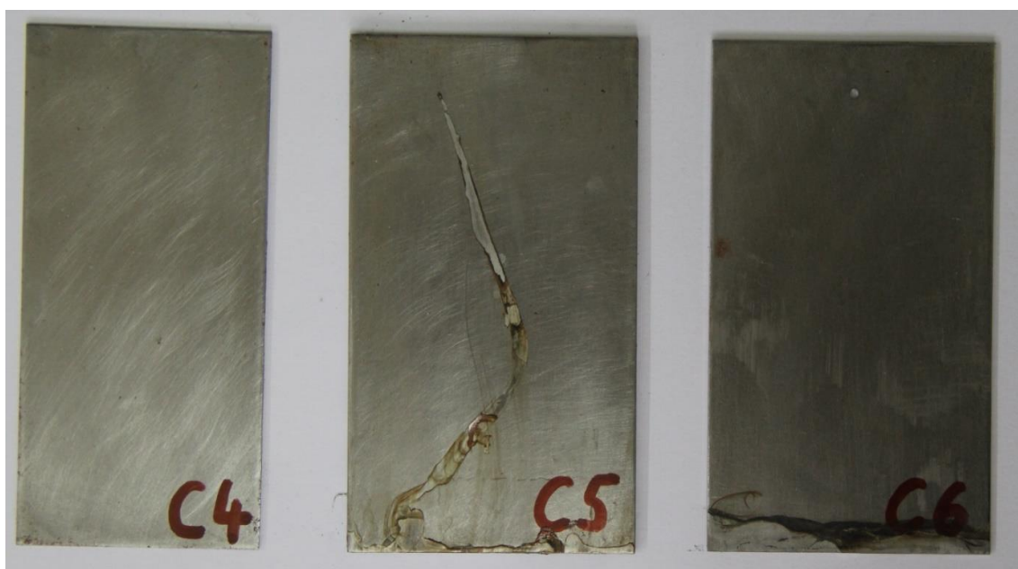
Slika 25. Rezultati ispitivanja uzoraka od čelika PE folijom debljine 120 \mu\text{m} u slanoj komori
