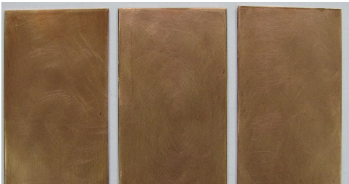
Slika 34. Rezultati ispitivanja uzoraka od bakra PE folijom debljine 100 \mu\text{m} u vlažnoj komori
