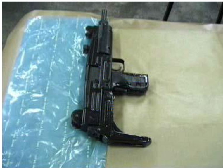
Slika 11. Primjena hlapljivih inhibitora korozije za zaštitu oružja [20]
