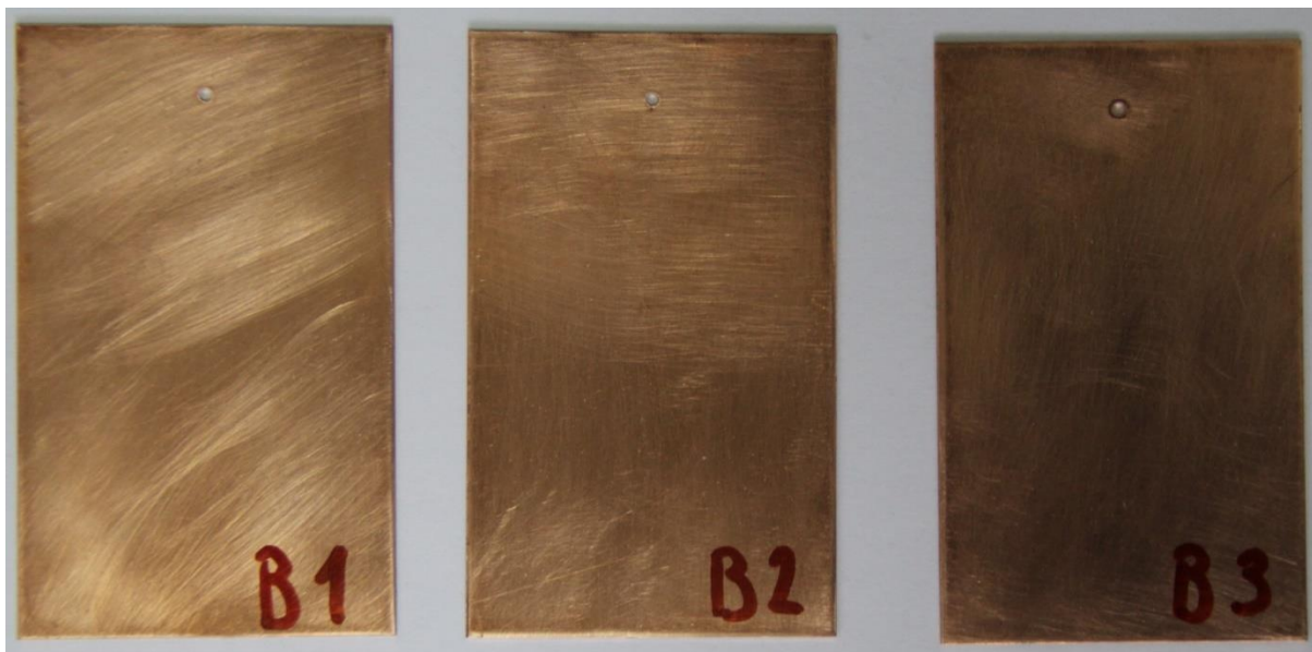
Slika 31. Rezultati ispitivanja uzoraka od bakra PE folijom debljine 80 \mu\text{m} u vlažnoj komori
