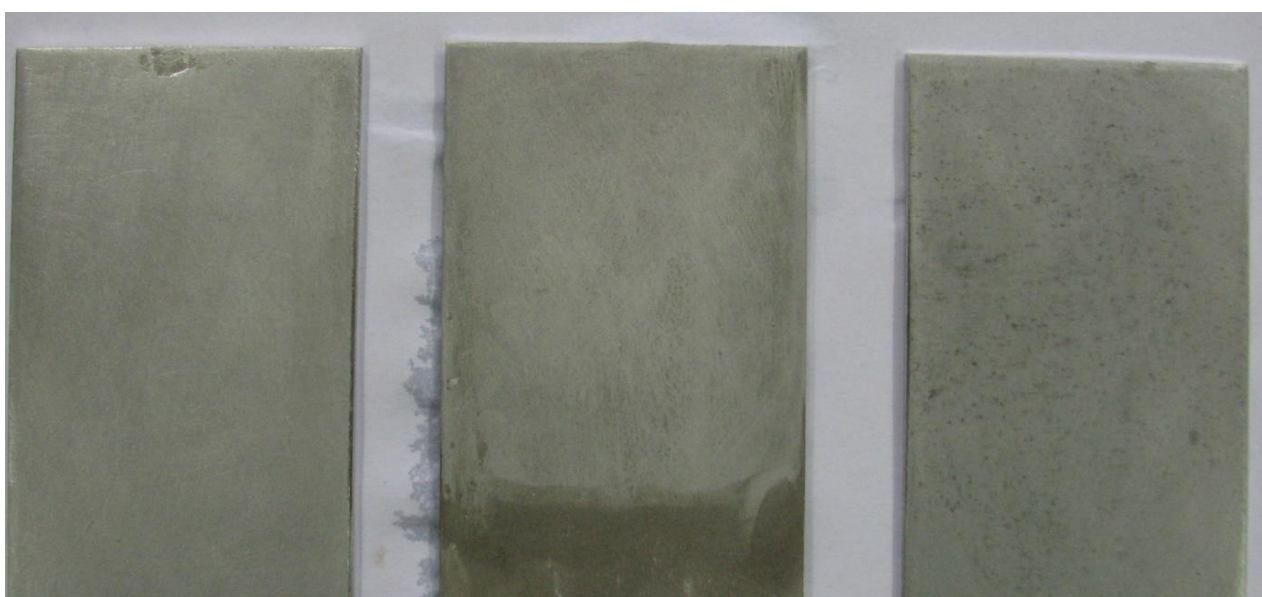
Slika 22. Rezultati ispitivanja uzoraka od aluminija PE folijom debljine 100 µm u slanoj komori
