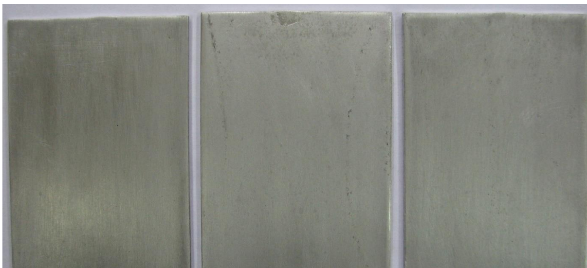
Slika 21. Rezultati ispitivanja uzoraka od aluminija PE folijom debljine 80 µm u slanoj komori
