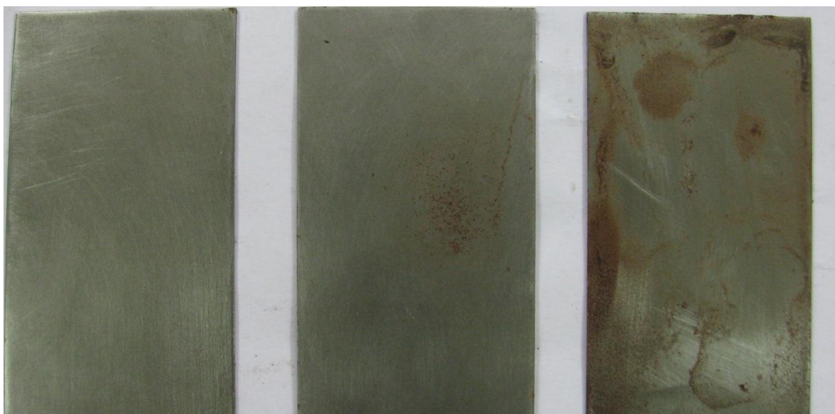
Slika 24. Rezultati ispitivanja uzoraka od čelika PE folijom debljine 100 \mu\text{m} u slanoj komori
