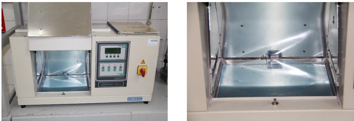
Slika 39. Uređaj za UV zračenje, SOLARBOX 522 (lijevo) i folija nakon UV zračenja (desno)
