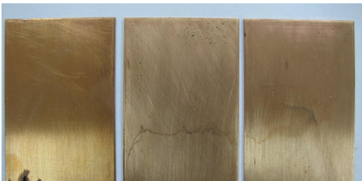
Slika 20. Rezultati ispitivanja uzoraka od bakra PE folijom debljine 80 \mu\text{m} u slanoj komori
