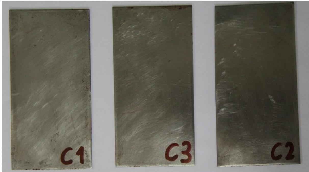
Slika 36. Rezultati ispitivanja uzoraka od čelika PE folijom debljine 120 µm u vlažnoj komori
