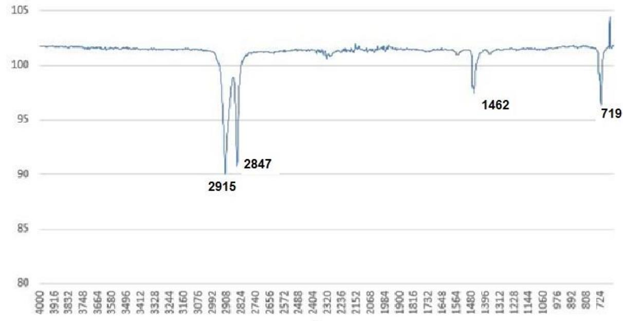
Slika 47. FTIR spektar PE folije od 80 µm, 100 µm i 120 µm s vanjske strane
