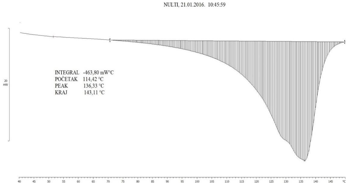
Slika 42. DSC krivulja za uzorak nulte probe
