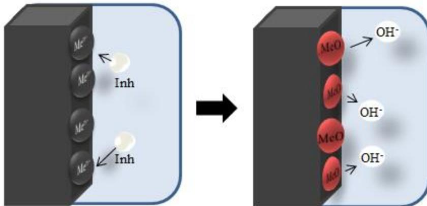
Slika 5. Učinak i mehanizam djelovanja anodnih inhibitora [17]
