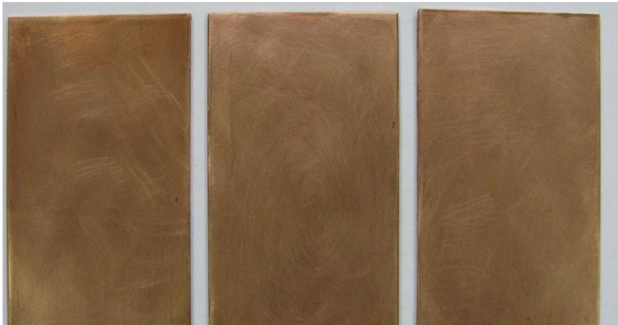
Slika 34. Rezultati ispitivanja uzorka od bakra PE folijom debljine 100  $\mu\text{m}$  u vlažnoj komori
