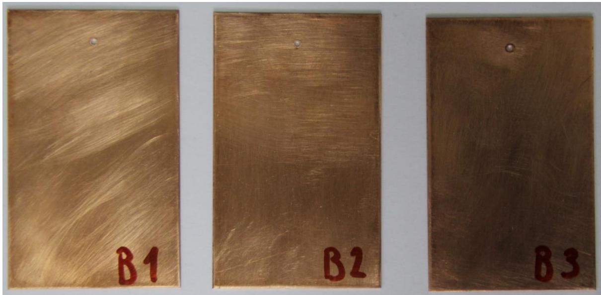
Slika 31. Rezultati ispitivanja uzorka od bakra PE folijom debljine 80  $\mu\text{m}$  u vlažnoj komori
