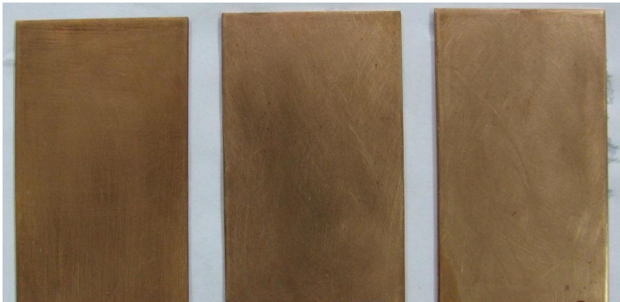
Slika 23. Rezultati ispitivanja uzorka od bakra PE folijom debljine 100 µm u slanoj komori
