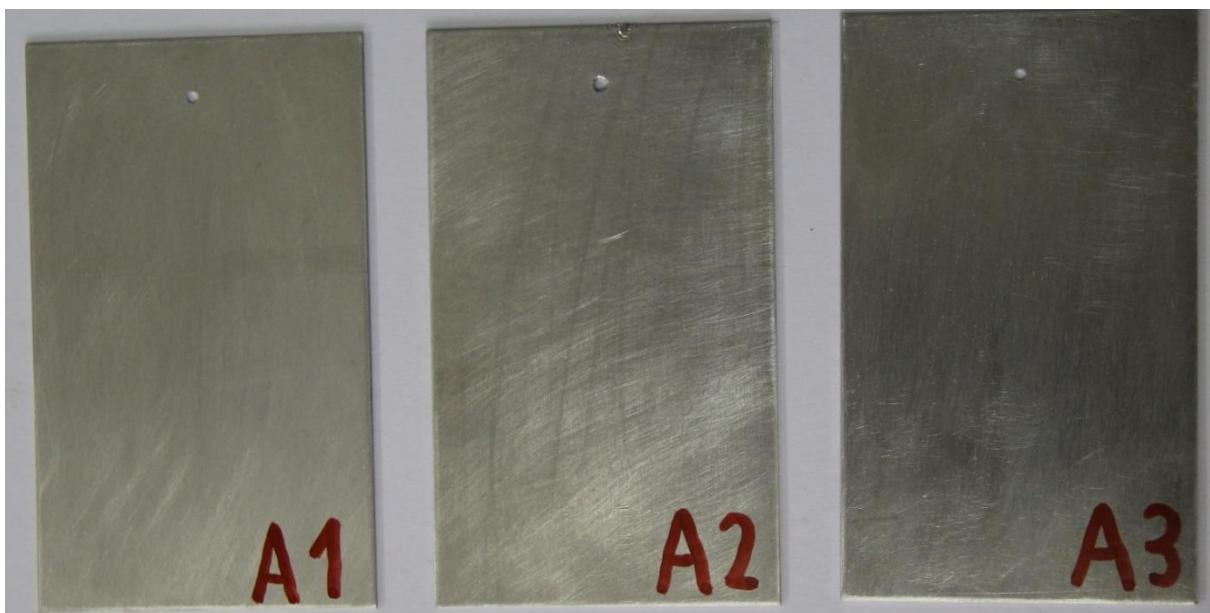
Slika 32. Rezultati ispitivanja uzorka od aluminija PE folijom debljine 80  $\mu\text{m}$  u vlažnoj komori
