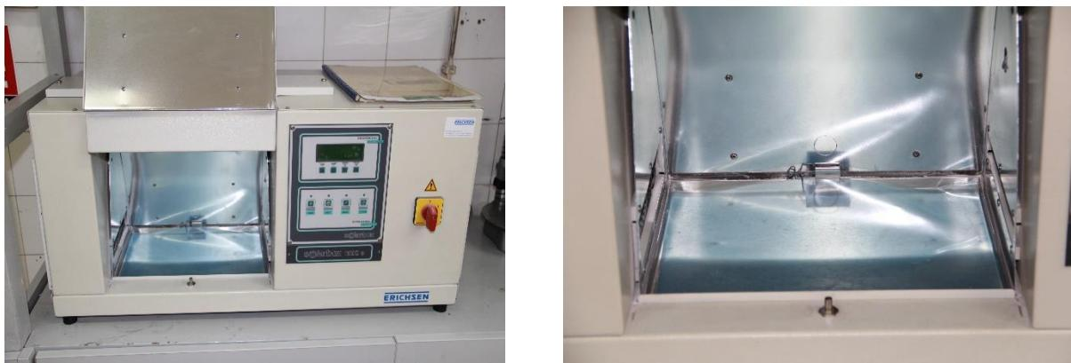
Slika 39. Uredaj za UV zračenje, SOLARBOX 522 (lijevo) i folija nakon UV zračenje (desno)
