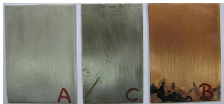
Slika 18. Nulte probe uzoraka aluminija (A), čelika (C) i bakra (B) u slanoj komori nakon 10 dana
