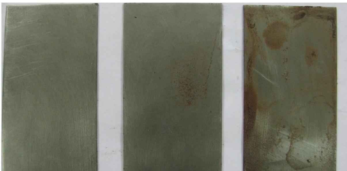
Slika 24. Rezultati ispitivanja uzorka od čelika PE folijom debljine 100 µm u slanoj komori
