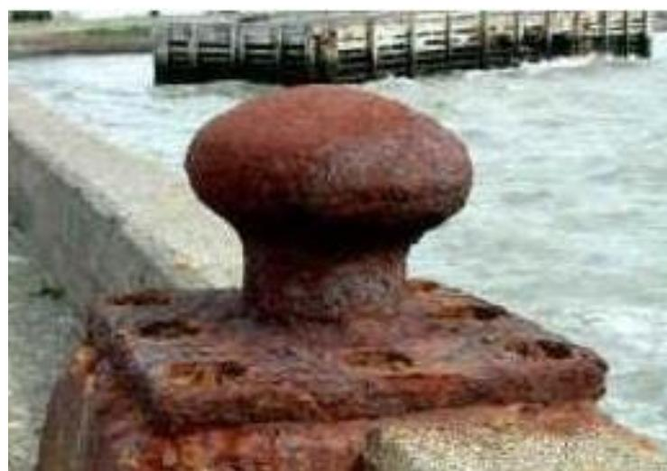
Slika 2. Primjer opće korozije [8]
