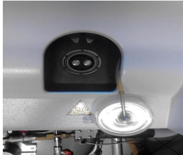
Slika 41. Posudica s uzorkom-ljevo i referentna posudica-desno
