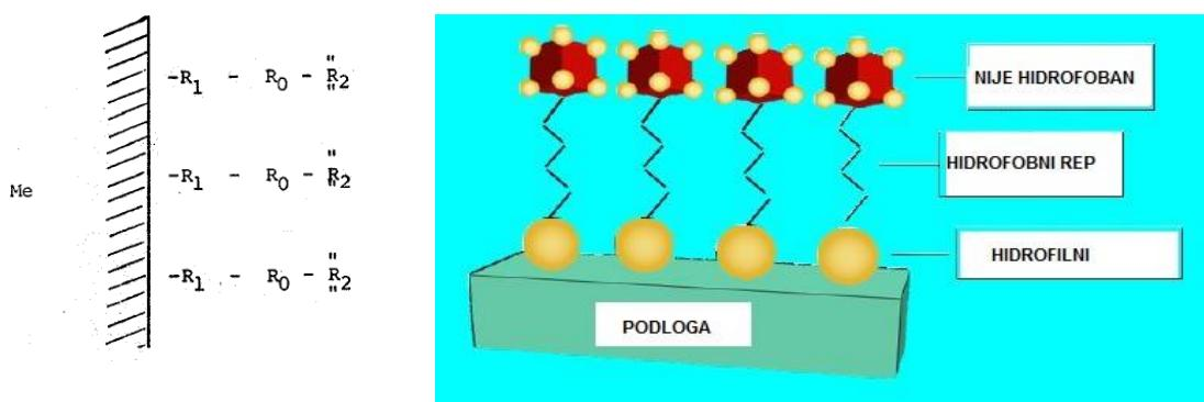
Slika 7. VCI adsorpcija na površinu metala [3]
