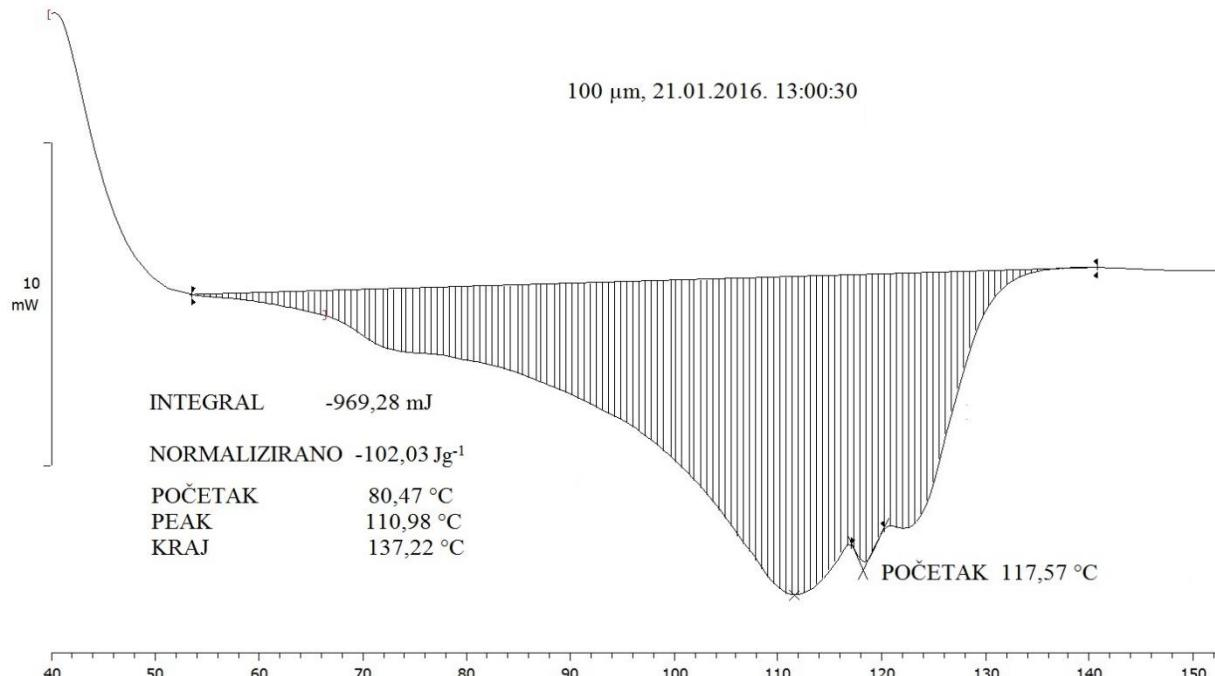
Slika 44. DSC krivulja za uzorak PE folije od 100 µm
