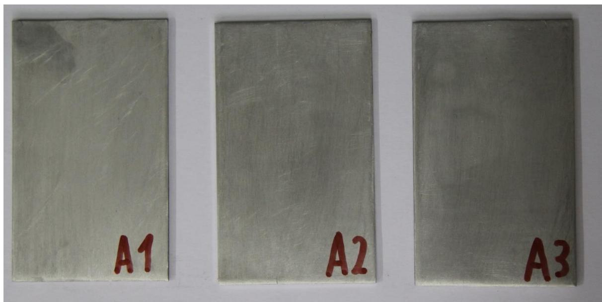
Slika 37. Rezultati ispitivanja uzoraka od aluminija PE folijom debljine 120 µm u vlažnoj komori
