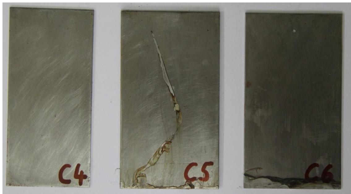
Slika 25. Rezultati ispitivanja uzorka od čelika PE folijom debljine 120  $\mu\text{m}$  u slanoj komori
