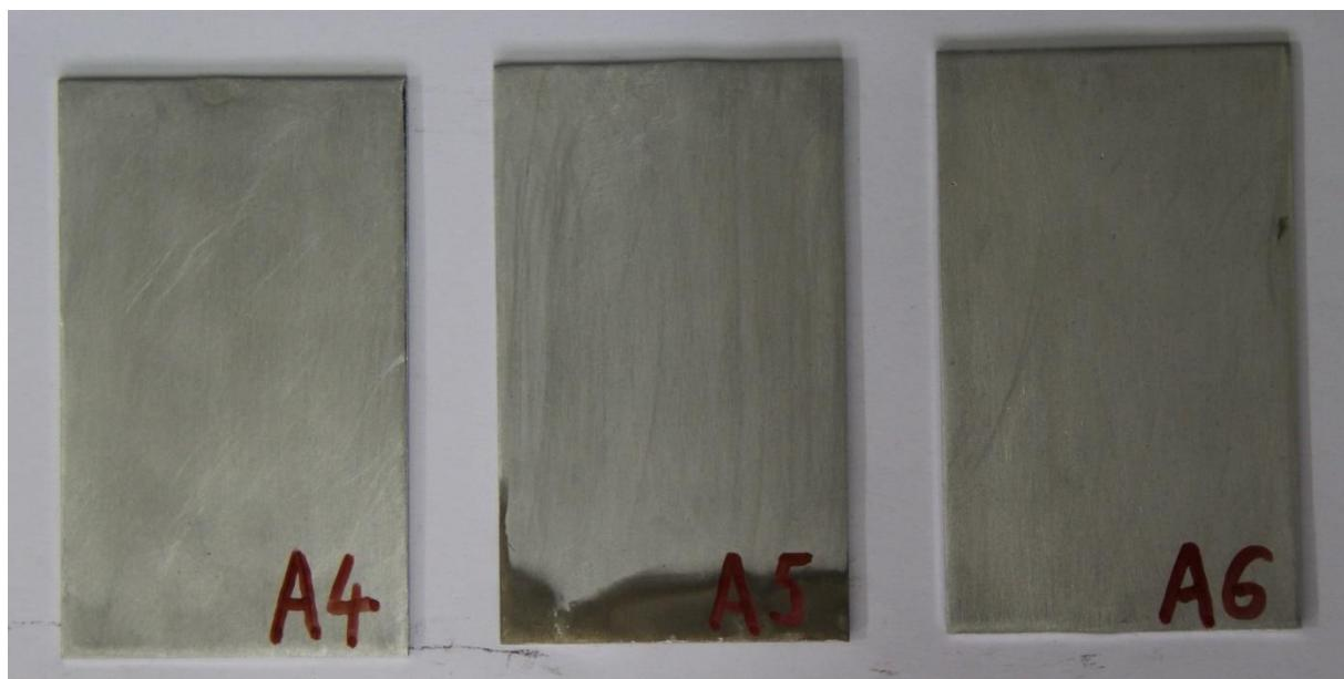
Slika 27. Rezultati ispitivanja uzorka od aluminija PE folijom debljine 120  $\mu\text{m}$  u slanoj komori
