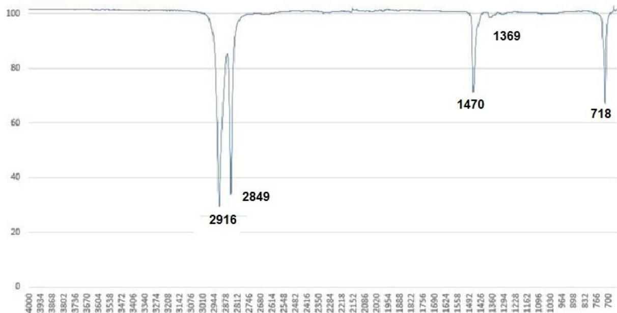
Slika 48. FTIR spektar PE folije od 80 µm sa stane inhibitora
