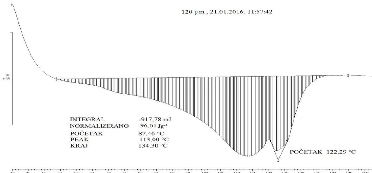
Slika 45. DSC krivulja za uzorak PE folije od 120 µm
