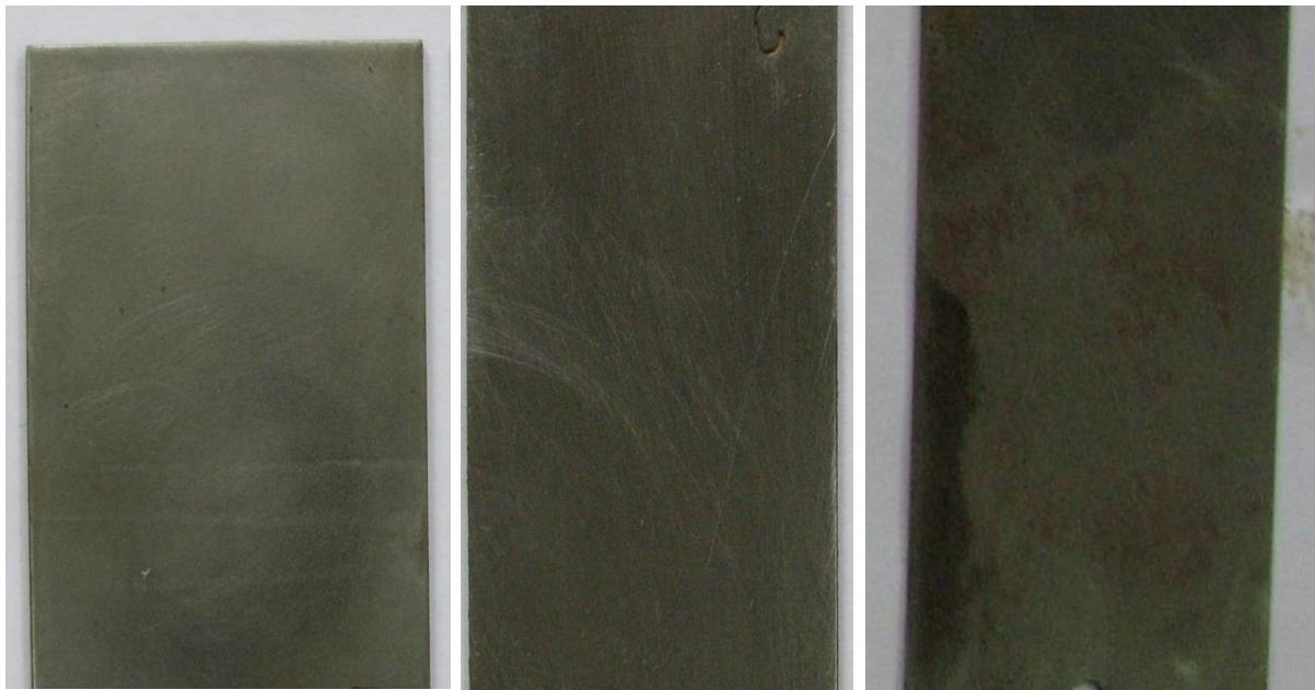
Slika 33. Rezultati ispitivanja uzorka od čelika PE folijom debljine 100 µm u vlažnoj komori
