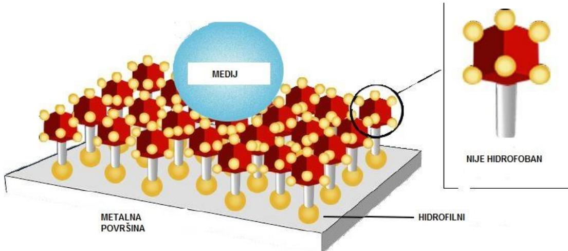
Slika 8. VCI adsorpcija gdje slobodni hidrofobni kraj odbija vodu s metalne površine i ne dopušta nakupljanje vlage [3]
