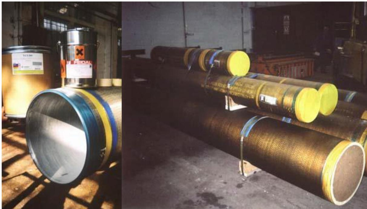
Slika 9. Zaštita unutrašnjosti cijevi inhibitorom korozije [20]
