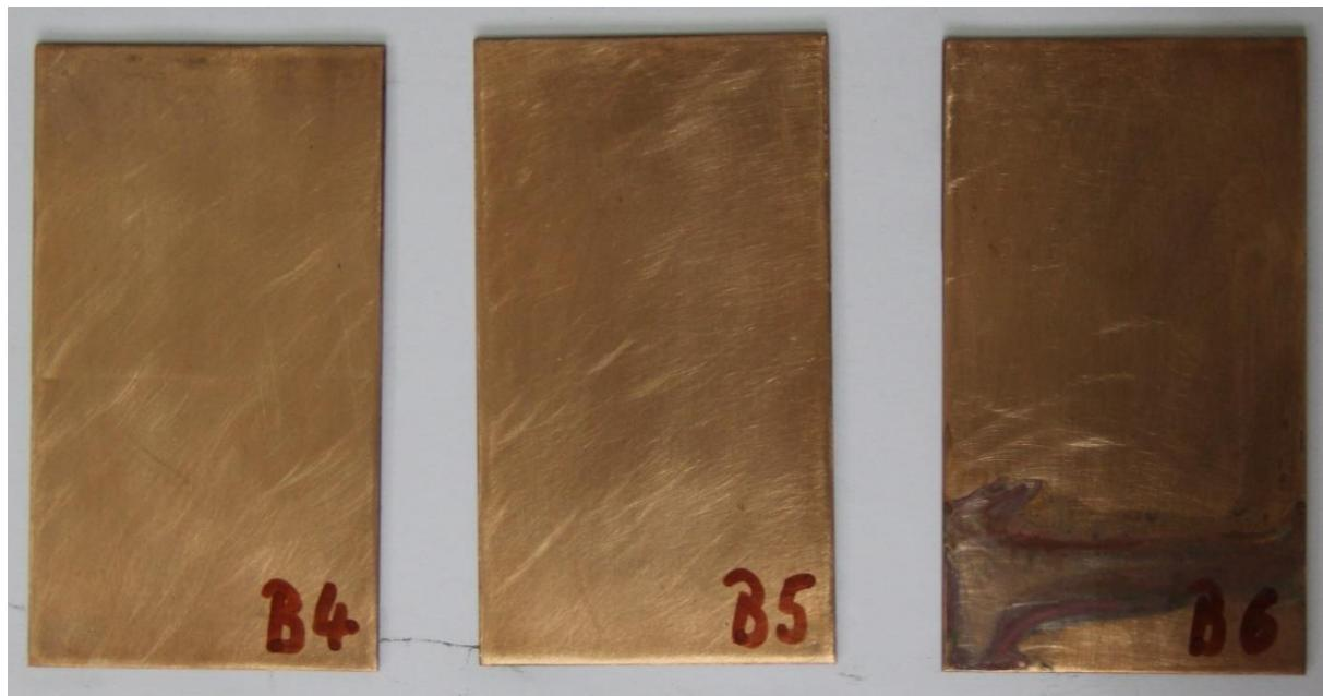
Slika 26. Rezultati ispitivanja uzorka od bakra PE folijom debljine 120  $\mu\text{m}$  u slanoj komori
