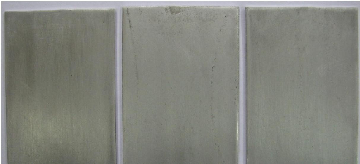
Slika 21. Rezultati ispitivanja uzorka od aluminija PE folijom debljine 80 µm u slanoj komori
