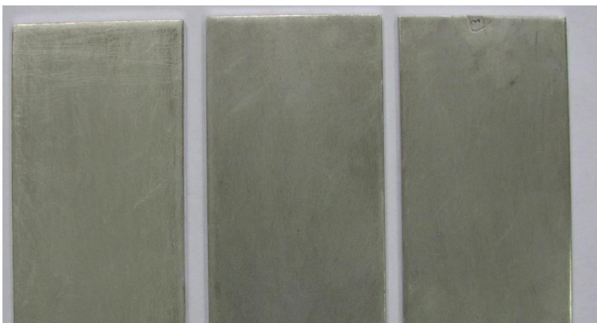
Slika 35. Rezultati ispitivanja uzorka od aluminija PE folijom debljine 100  $\mu\text{m}$  u vlažnoj komori
