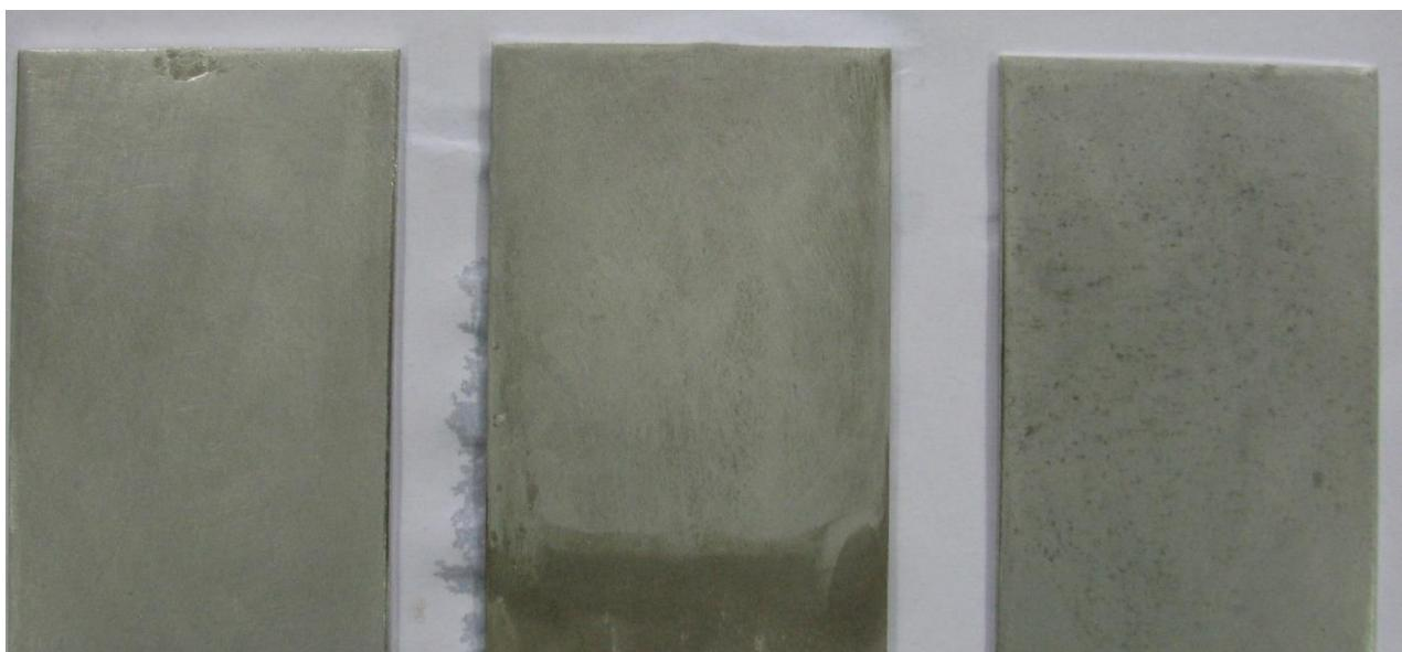
Slika 22. Rezultati ispitivanja uzorka od aluminija PE folijom debljine 100 µm u slanoj komori
