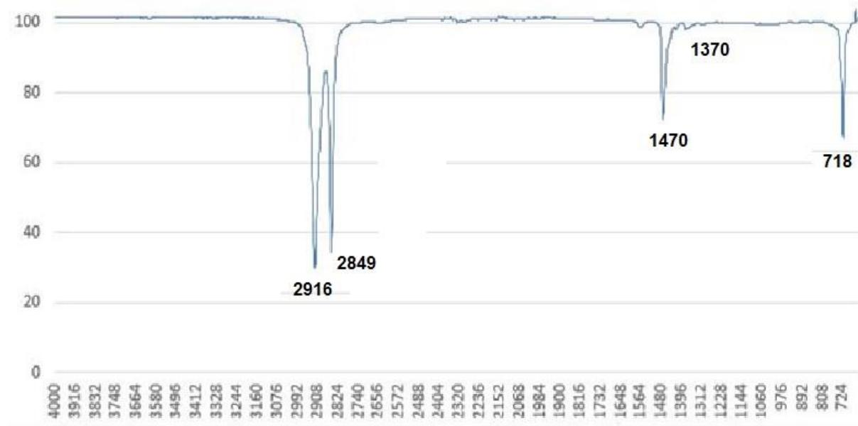
Slika 50. FTIR spektar folije od 100  $\mu\text{m}$  sa stane inhibitora
