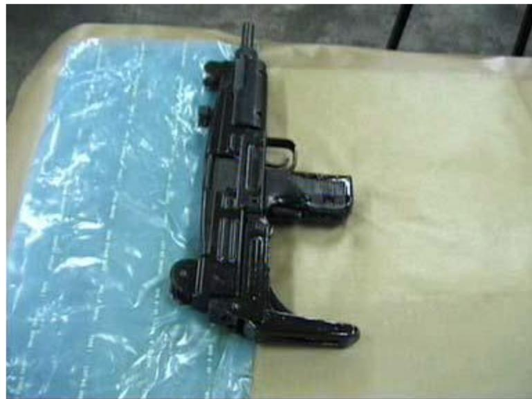
Slika 11. Primjena hlapljivih inhibitora korozije za zaštitu oružja [20]
