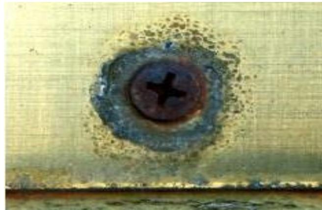
Slika 3. Primjer galvanske korozije [9]
