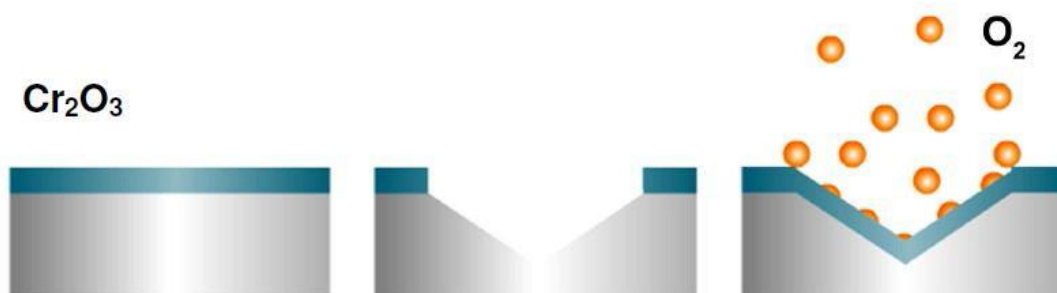
Slika 6. Prikaz mehanizma samoobnavljanja pasivnog filma kromovih oksida na površini [12]
