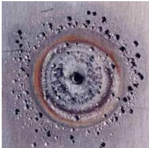
Slika 10. Primjer oštećenja uzrokovanog rupičastom korozijom [18]
