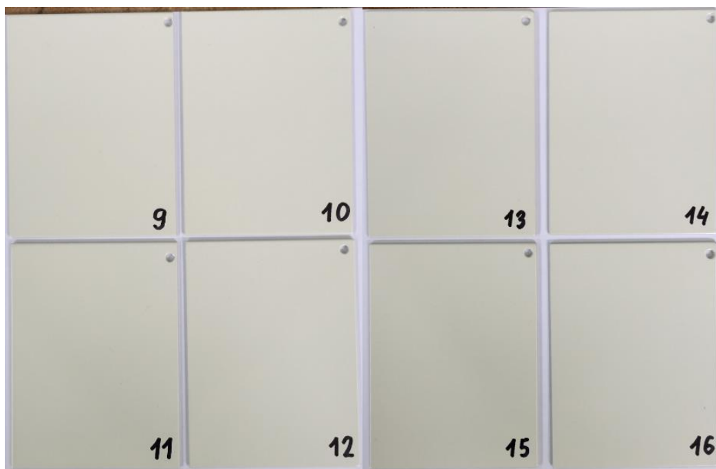
Slika 22. Uzorci nakon kemijske obrade (9-12) i nakon staklarenja (13-16)
