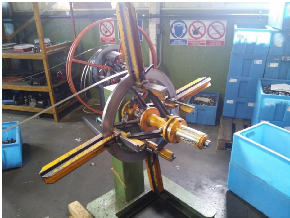
Slika 6. Kolut lima postavljen na odmotač s kojeg se lim pomoću dodavača transportira do štanice (alata)
