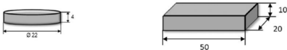
Slika 22. Oblik i dimenzije uzoraka za ispitivanje [16]
