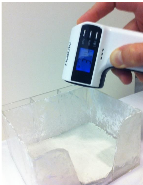
Slika 14. Mjerenje površinske temperature [12]
