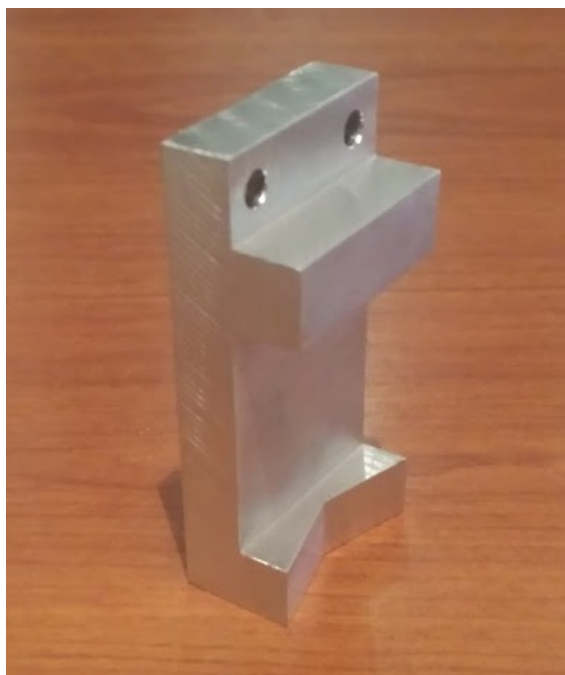
Slika 27 - Mehanički prst hvataljke prikladan za hvatanje cilindričnih tijela
