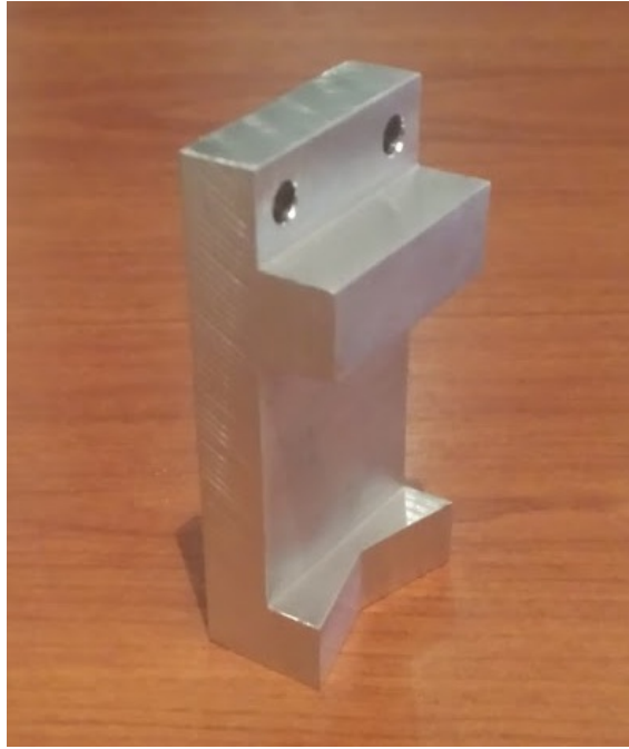
Slika 27 - Mehanički prst hvataljke prikladan za hvatanje cilindričnih tijela
