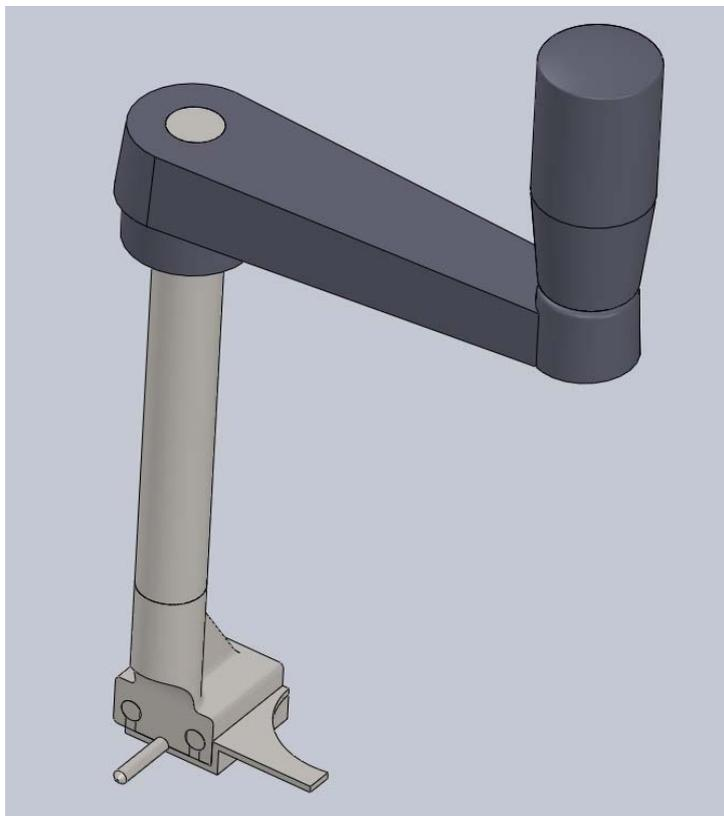
Slika 24. Vratilo s rucicom u obradnom glavom
