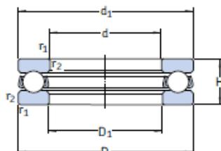
Slika 56. Kuglični aksijalni ležaj, preuzeto iz [12]
