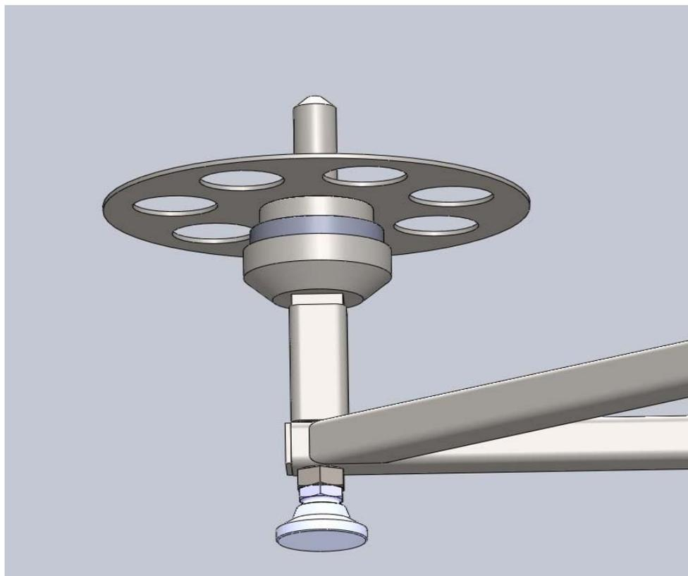
Slika 49. Uređaj za savijanje žice - nosač koluta žice
