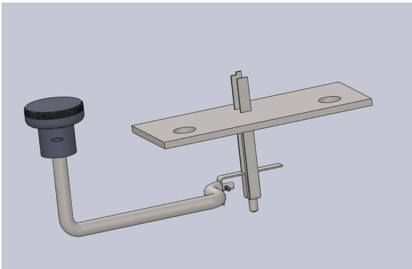
Slika 35. Mehanizam izbacivača - alat 1
