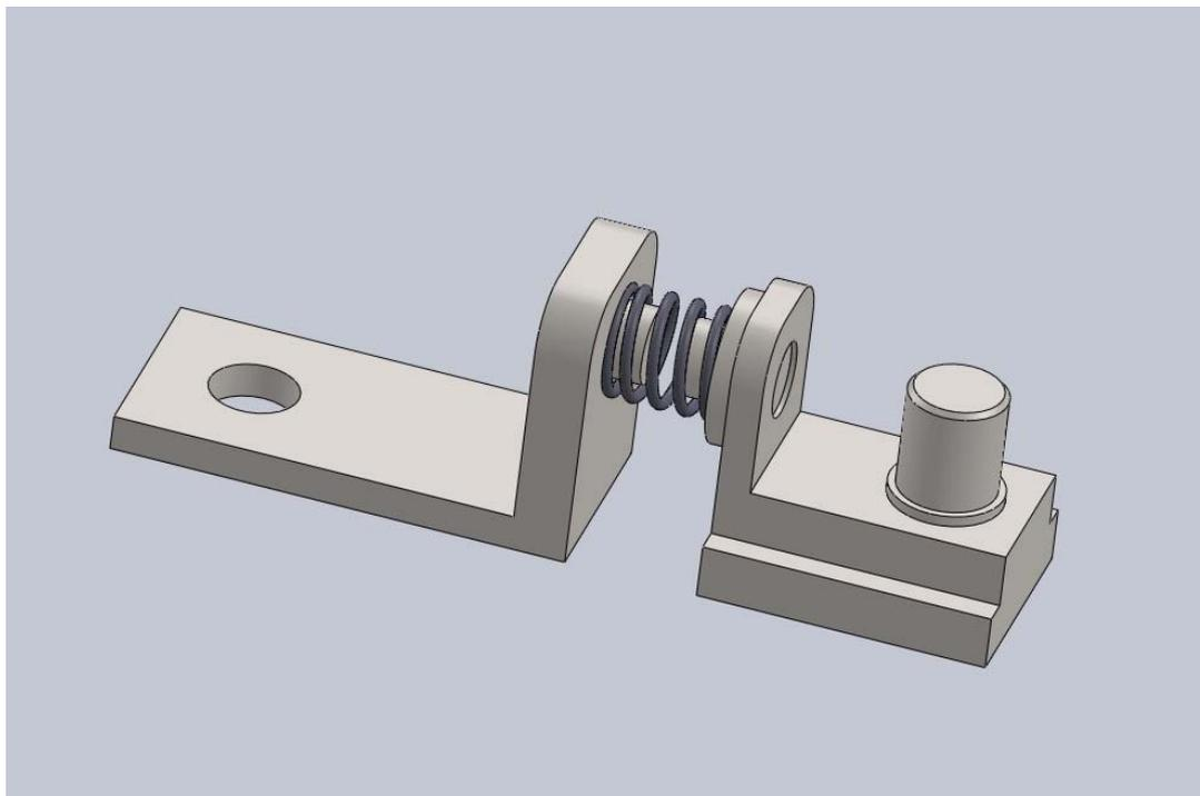
Slika 33. Opružni mehanizma
