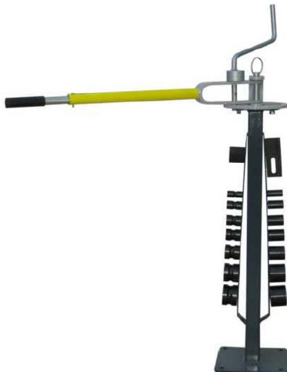
Slika 8. Univerzalni alat za savijanje UBM – preuzeto sa [3]
