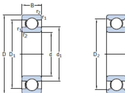
Slika 54. Kuglični radijalni ležaj, preuzeto iz [12]
