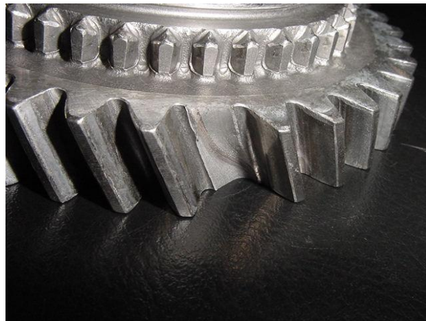
Slika 8. Lom zuba uslijed zamora materijala [7]
