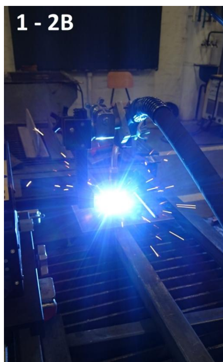
Slika 31. Navarivanje strujom 175 A i plinskom mješavinom Ferroline C6 X1
