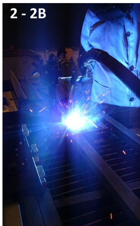
Slika 31. Navarivanje strujom 175 A i plinskom mješavinom Ferroline C6 X1
