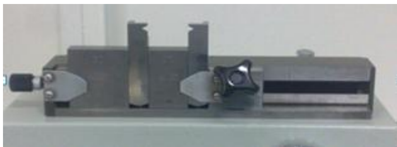
Slika 16. Stezna naprava za mjerke s V-utorom
