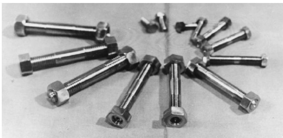
Slika 4. SPD postupkom obrađeni vijci od titana [2]
