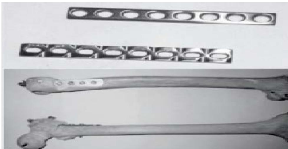
Slika 5. Primjena u medicini- titanske perforirane trake [2]
