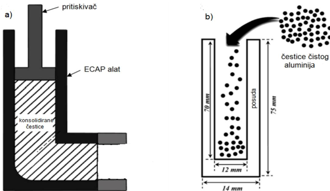
Slika 15. Primjena ECAP tehnologije u metalurgiji praha: [1]
