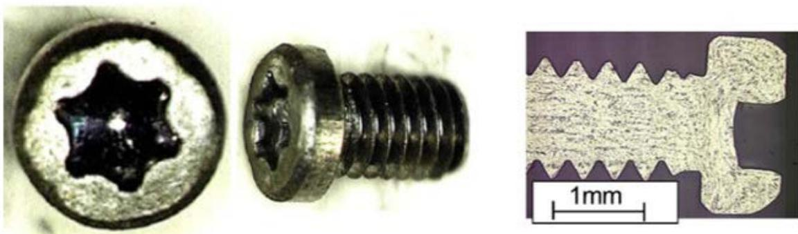
Slika 7. Vijci primjenjeni u dentalnoj medicini izrađeni ECAP-om [4]
