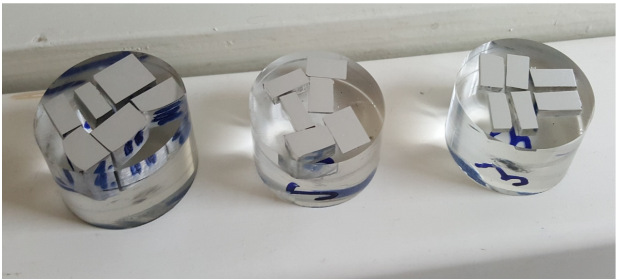
Slika 32. Pripremljeni i nagriveni uzorci
