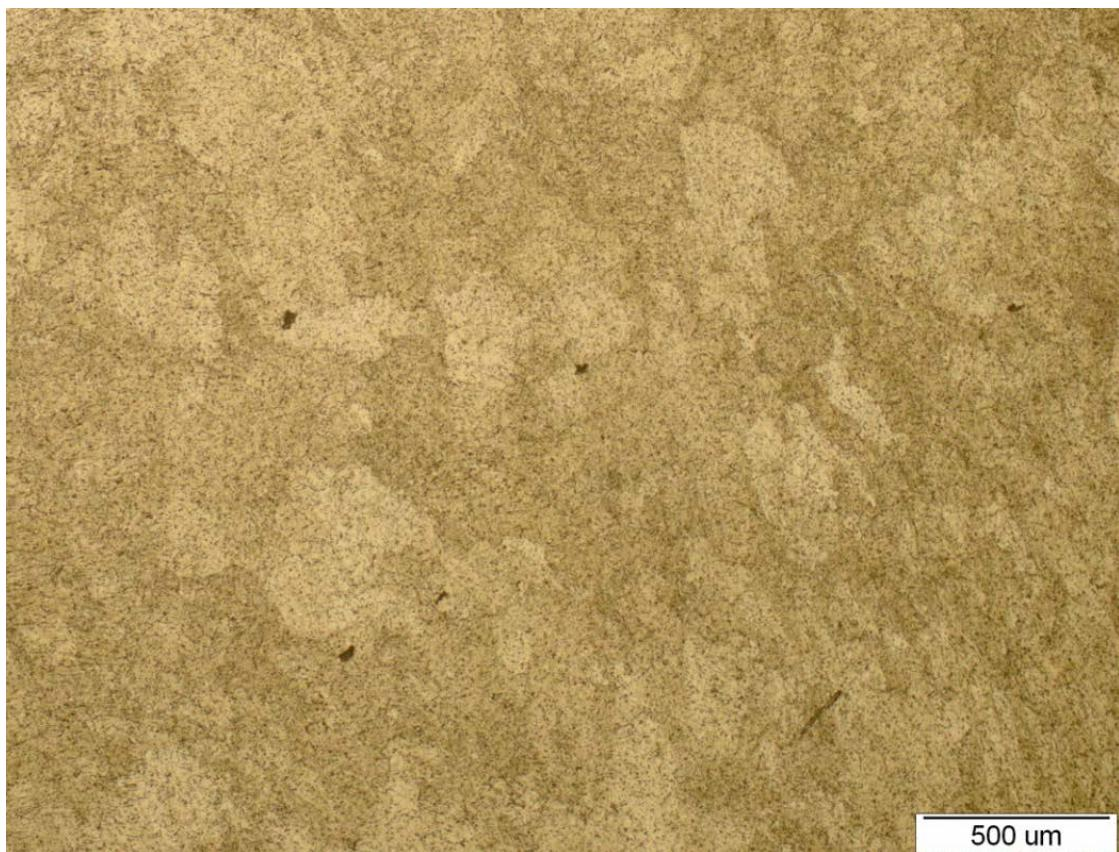
Slika 34. Poprečni presjek jednom provučenog uzorka, povećanje 50x
