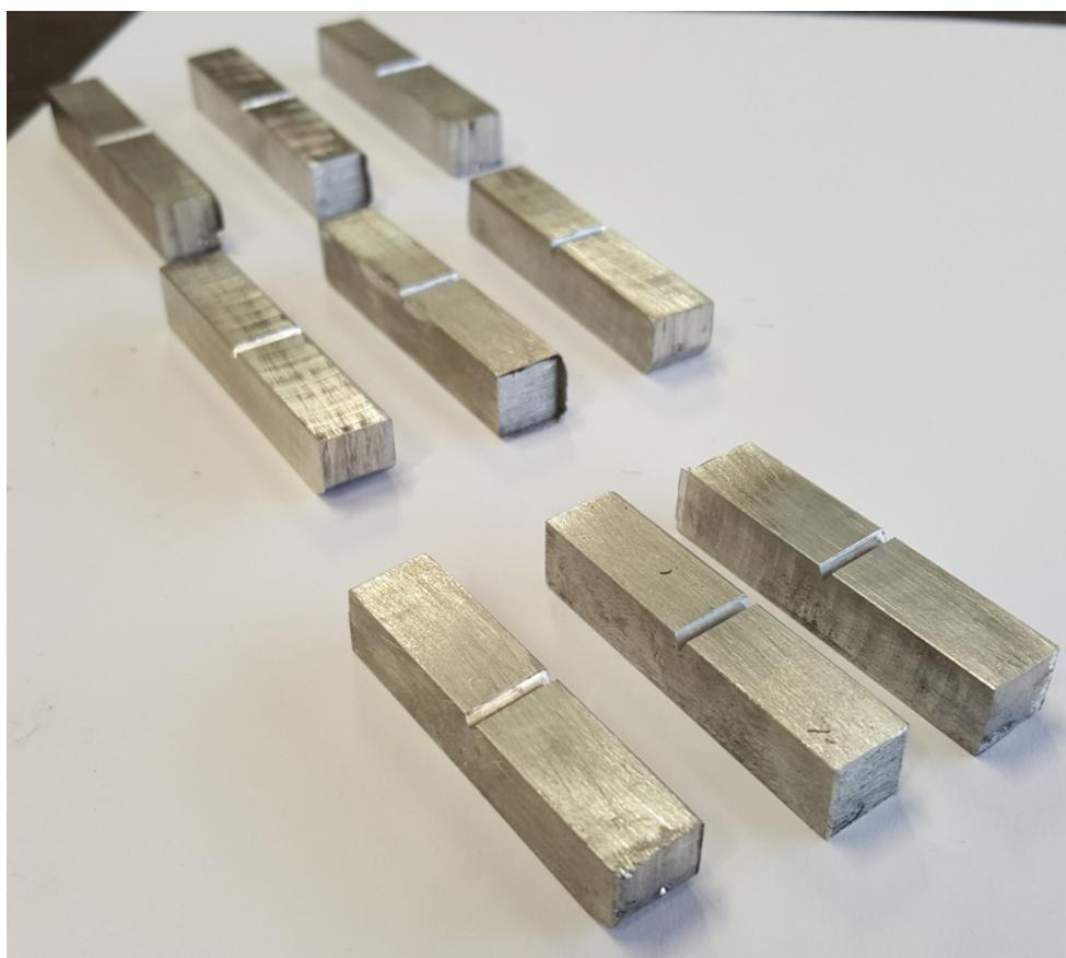
Slika 42. Uzorci sa V zarezom prije ispitivanja žilavosti
