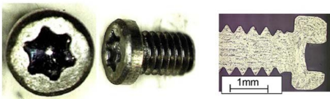
Slika 7. Vijci primijenjeni u dentalnoj medicini izrađeni ECAP-om [4]
