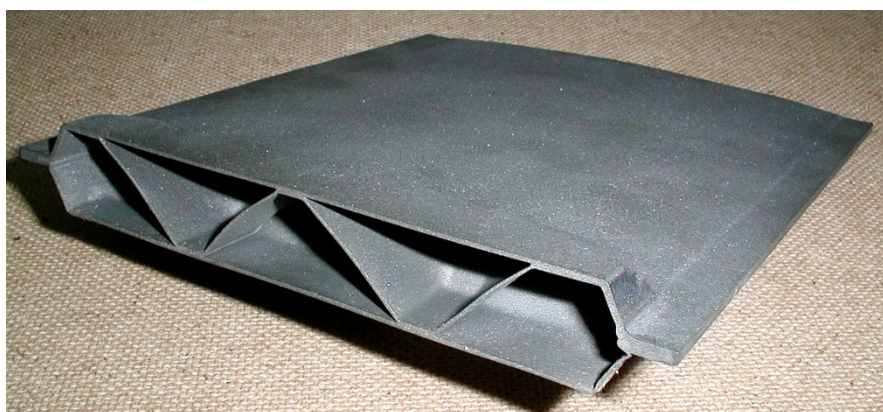
Slika 3. Dio konstrukcije zrakoplova od titan legure podvrgnute SPD-u [6]
