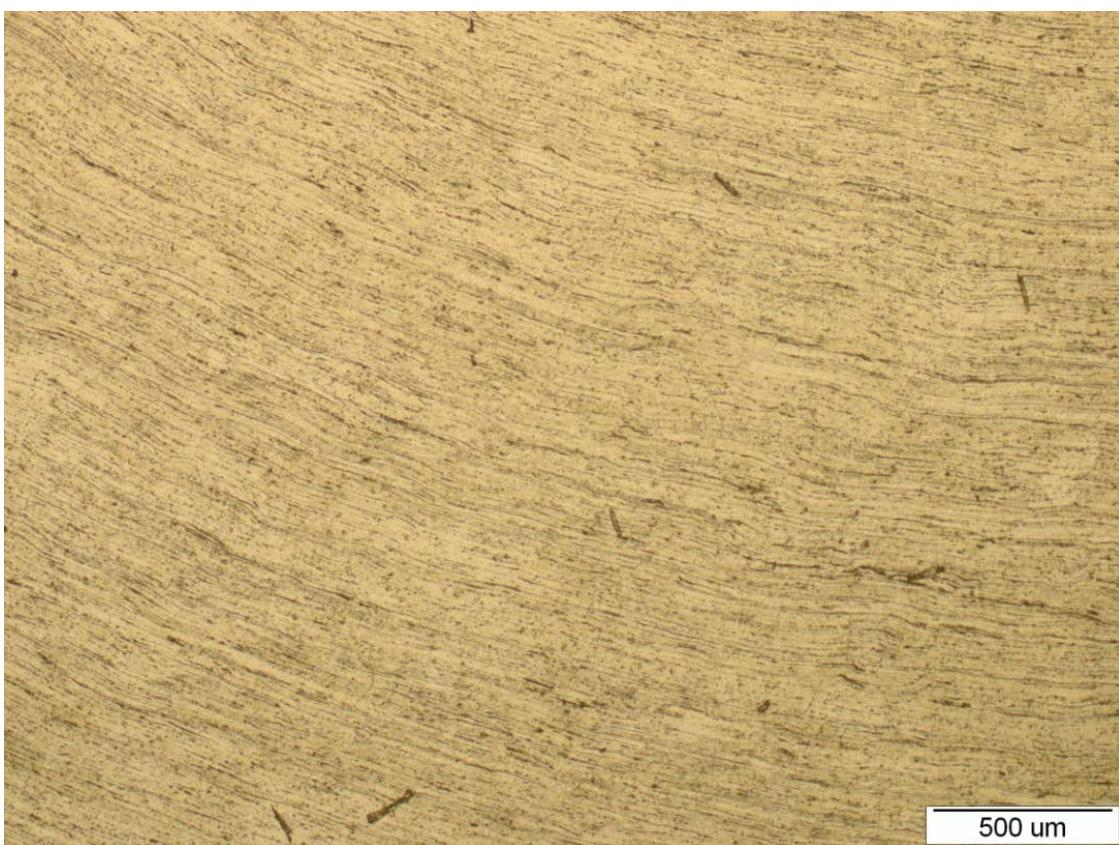
Slika 35. Uzdužni presjek jednom provučenog uzorka, povećanje 50x
