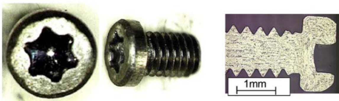
Slika 7. Vijci primijenjeni u dentalnoj medicini izrađeni ECAP-om [4]
