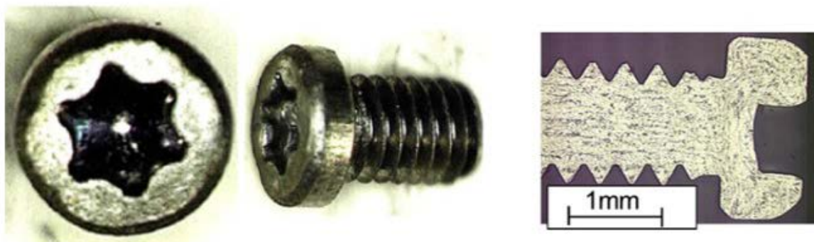
Slika 7. Vijci primijenjeni u dentalnoj medicini izrađeni ECAP-om [4]
