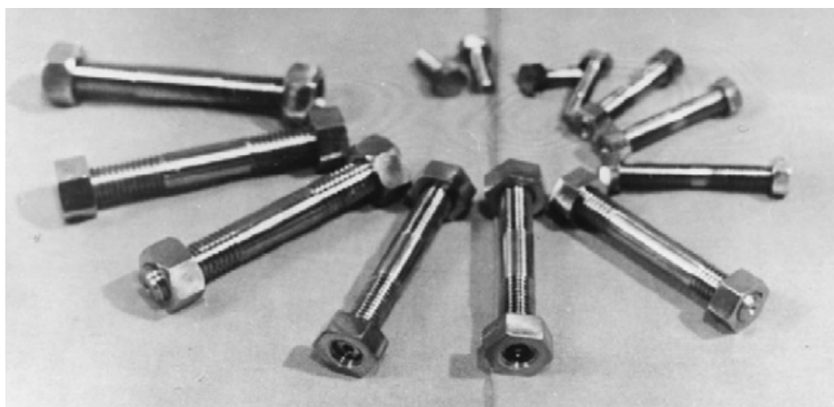
Slika 4. SPD postupkom obrađeni vijci od titana [2]
