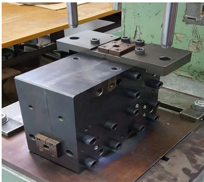
Slika 21. Zatvoreni ECAP kalup
