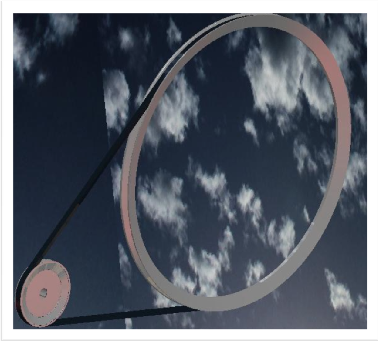
Slika 6 : remen SPZ 2500L w DIN 7753 (HRN G.E2.063)
