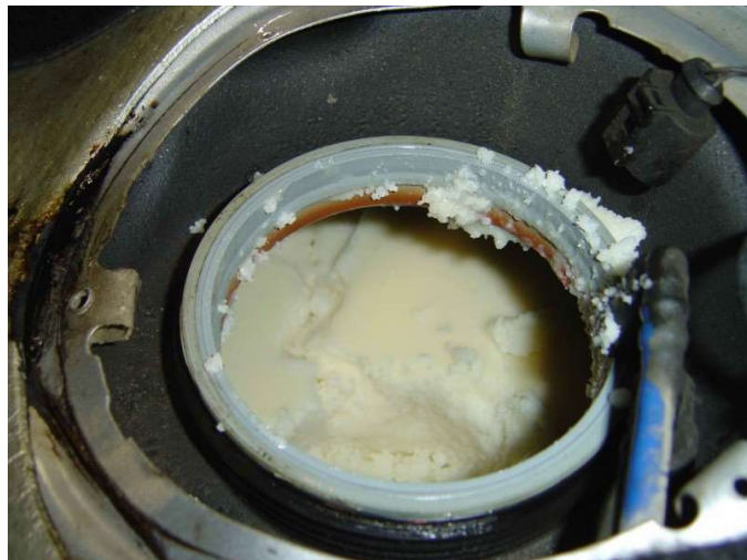
Slika 17. Nakupine voska na filteru u dizelskom motoru [8]
