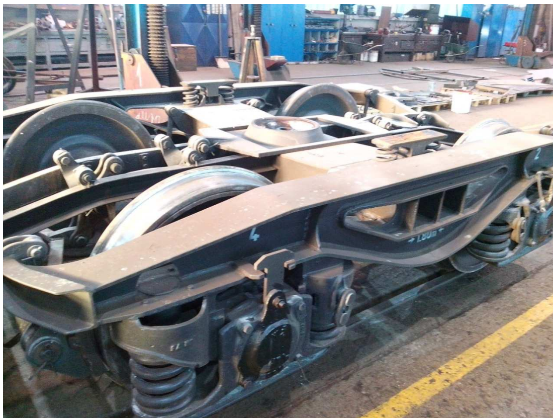
Slika 2. Okretno podvozje Y25 na redovnom remontu u tvornici RŽV Čakovec
