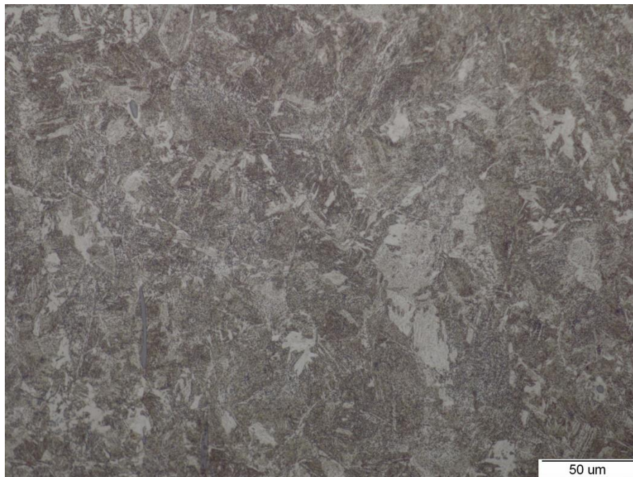
Slika 30. Fotografija mikrostrukture na kojoj je određena veličina zrna
