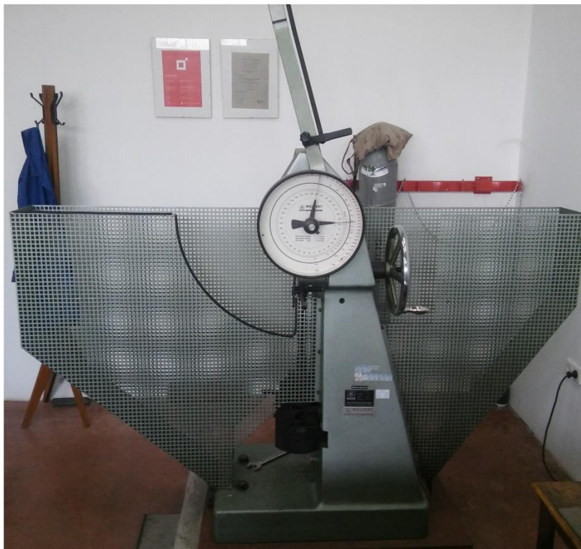
Slika 37. Charpyjev bat „Otto Wolpert-Werke GmbH“
