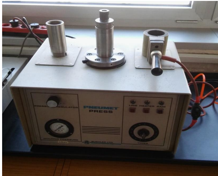
Slika 17. Preša za toplo zalijevanje metalografskih uzoraka
