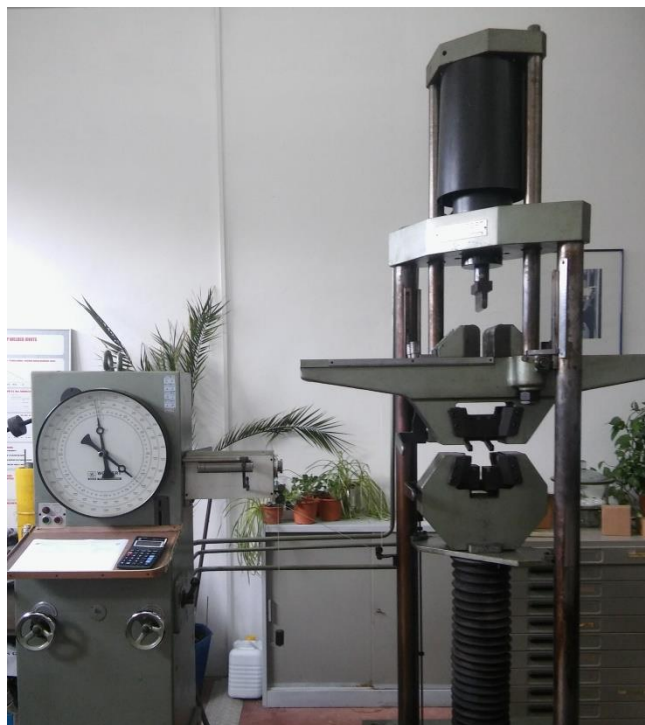
Slika 35. Hidraulička kidalica WOLPERT
