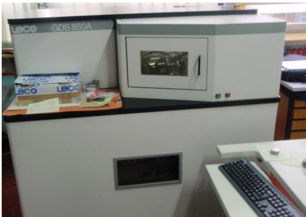
Slika 15. Optički emisijski spektrometar LECO GDS 850A
