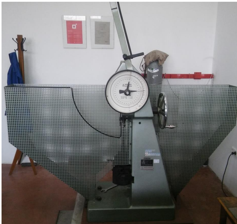
Slika 37. Charpyjev bat „Otto Wolpert-Werke GmbH“
