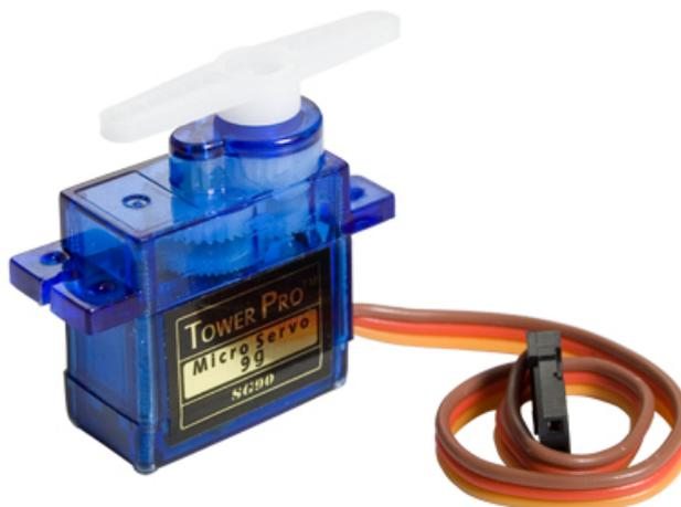
Slika 8. Električni motor Tower Pro Micro Servo SG90
