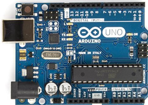
Slika 7. Mikrokontroler Arduino UNO R3
