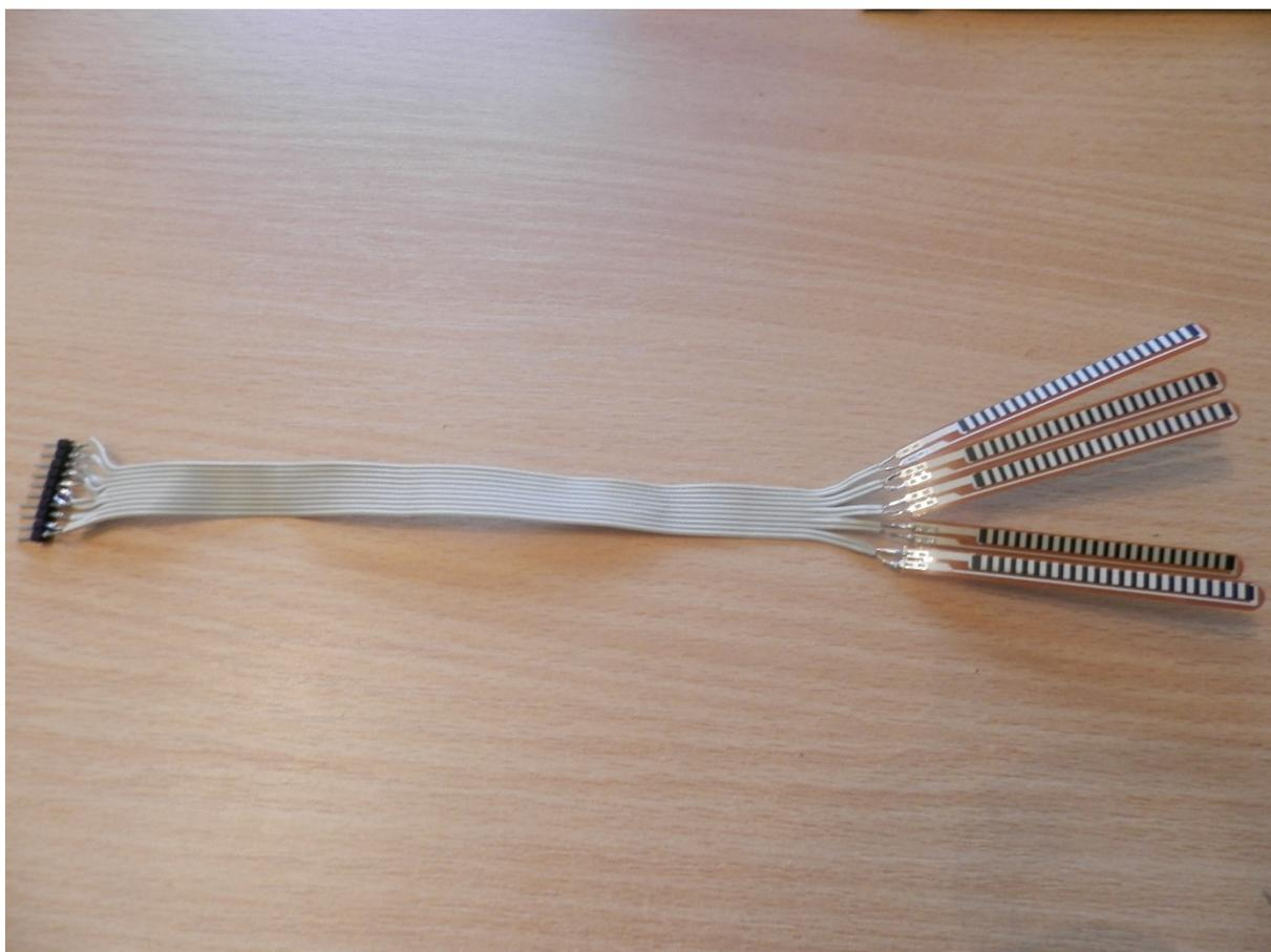
Slika 31. Zalemljeni senzori
