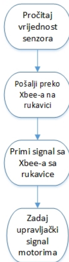
Slika 29. Tok upravljanja sustava
