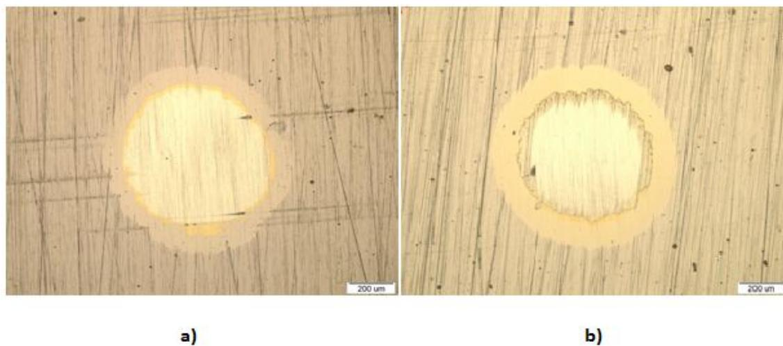
**Slika 6.3.** Trag trošenja na čeliku K390 MC snimljen na svjetlosnom mikroskopu nakon ispitivanja debljine prevlake metodom utiskivanja kuglice:a) na uzorcima C2 s TiN/TiCN prevlakom, b) na uzorcima C3 s TiN/TiBN prevlakom
