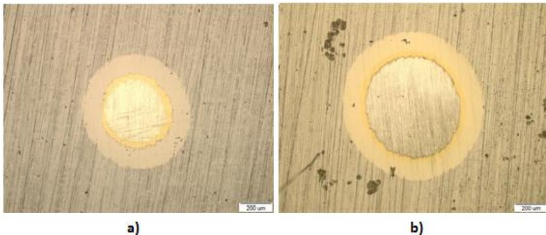
**Slika 6.2.** Trag trošenja na čeliku K110 snimljen na svjetlosnom mikroskopu nakon ispitivanja debljine prevlake metodom utiskivanja kuglice:a) na uzorcima D2 s TiN/TiCN prevlakom, b) na uzorcima D3 s TiN/TiBN prevlakom
