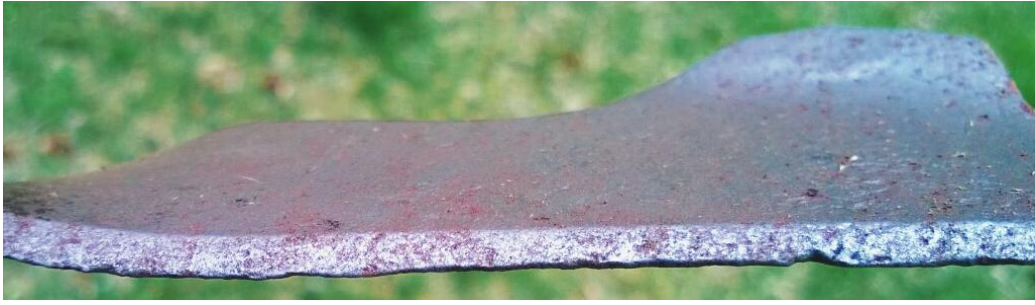
Slika 18. Potrošena oštrica noža nakon razdoblja vegetacije, [31]
