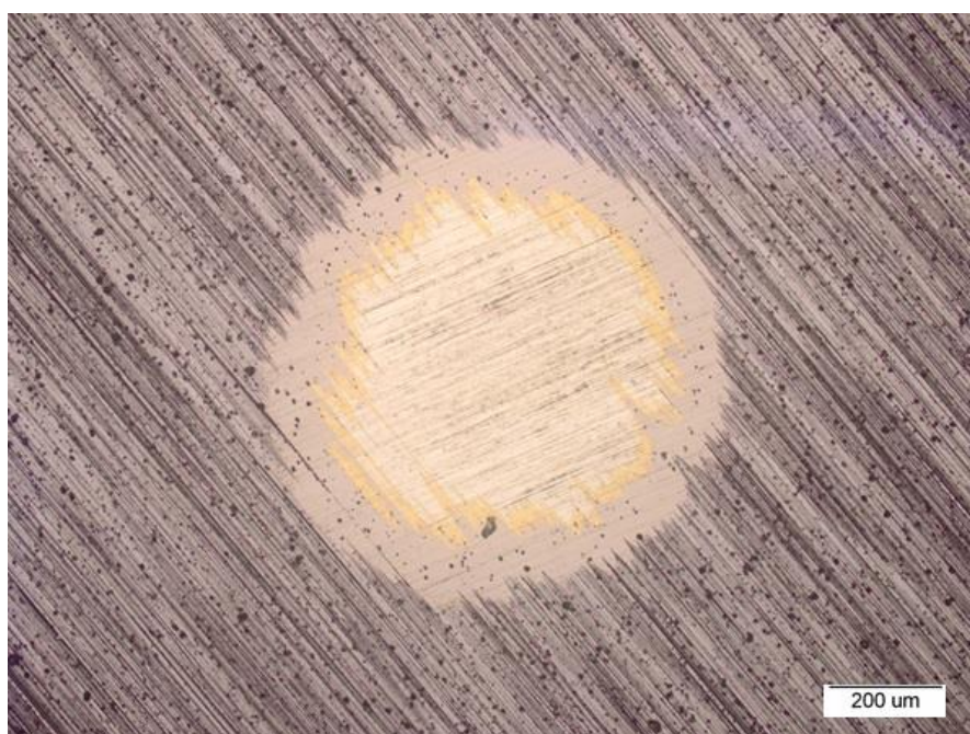
Slika 30. Otisak kalote na uzorku C2 02
