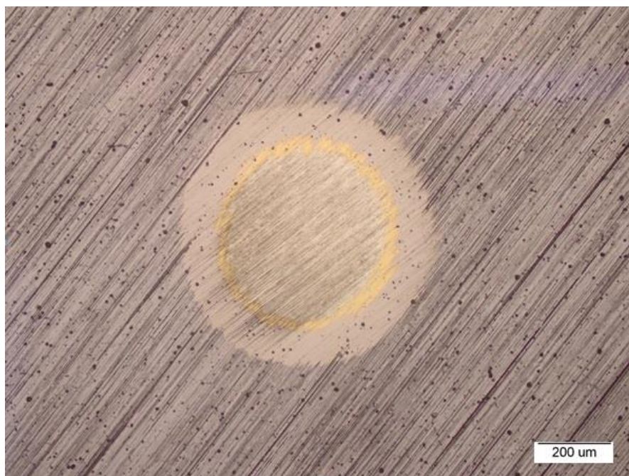
Slika 31. Otisak kalote na uzorku D2 02
