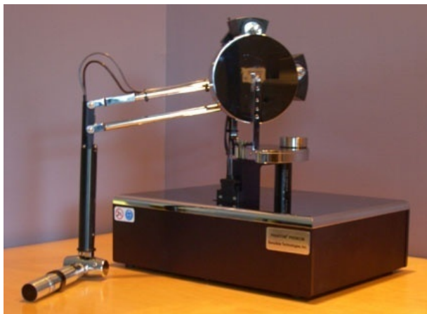
Slika 9. PHANToM Premium 1.5 6DOF
