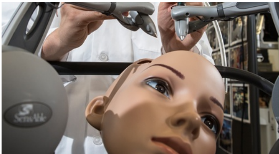
Slika 34. Prikaz haptičkih uređaja kod simulacije operacije glave [25]
