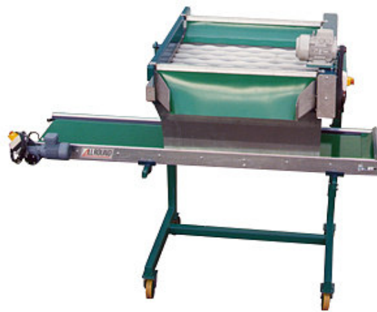
Slika 3.4. Stroj za četkanje krumpira Schouten
