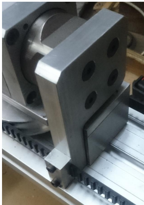
Slika 33. Spoj klipa cilindra i remenskog prijenosa
