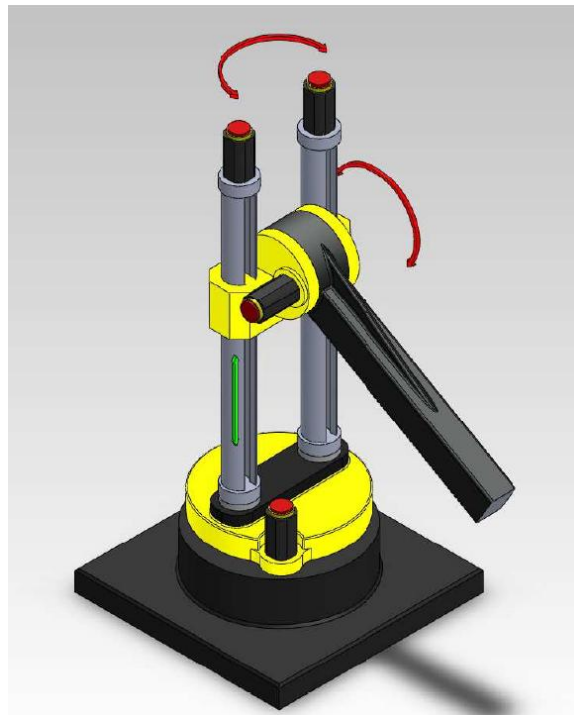
Slika 2. Stupnjevi slobode običnog manipulatora
