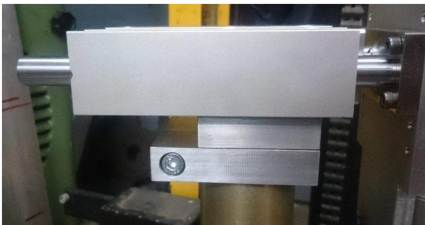
Slika 35. Spoj rotirajuće osovine i cilindra MGPM25R-100
