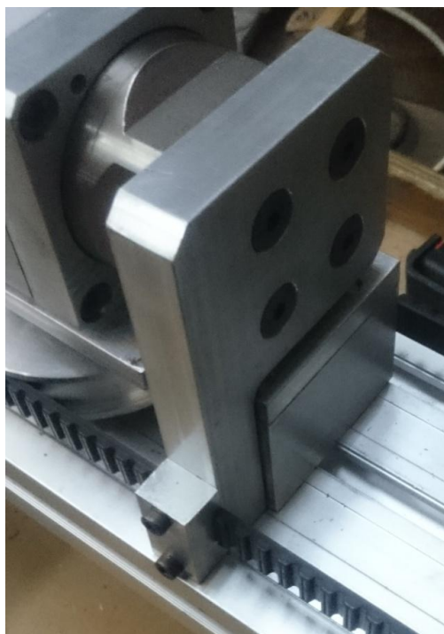
Slika 33. Spoj klipa cilindra i remenskog prijenosa
