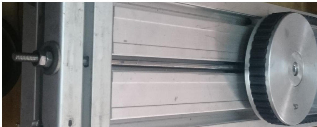
Slika 30. Zategnuti remen preko remenice 2
