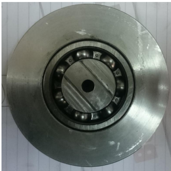
Slika 27. Remenica 2 s kugličnim ležajem
