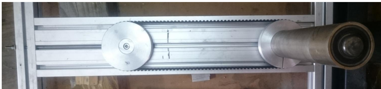
Slika 23. Spoj remenica i rotirajuće osovine na profilirani stol
