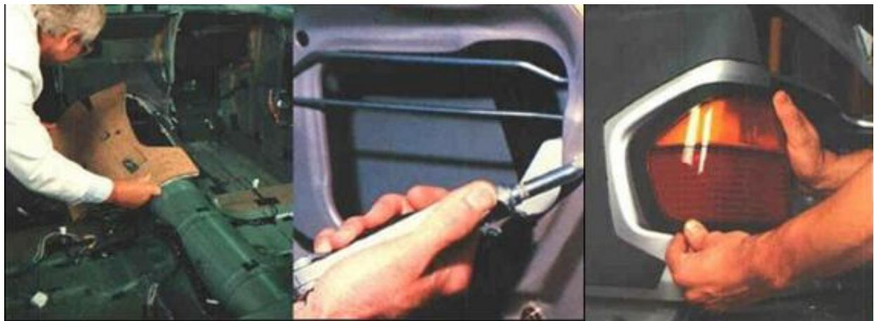
Slika 34. Lijepljenje dijelova automobila [30]
