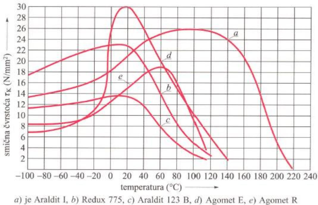
Slika 9. Smična čvrstoća raznih ljepila ovisno o temperaturi [3]
