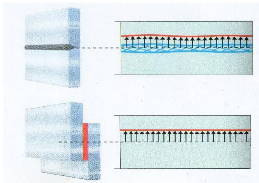
Slika 21. Usporedba naprezanja kod zavarenog i lijepljenog spoja [8]
