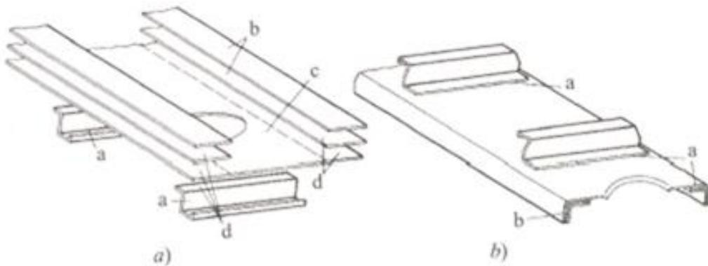
Slika 30. Primjena ljepila na zrakoplovnim nosačima [3]
