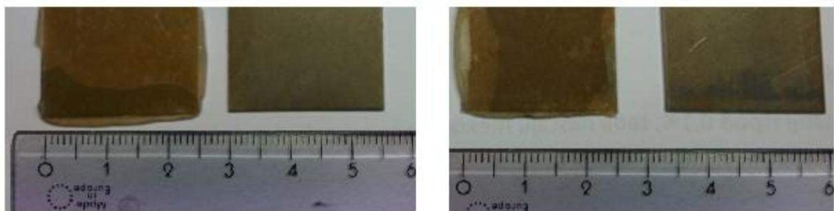
Slika 47. Adhezijski lom uzorka 1 (desno) i 2 (lijevo)
