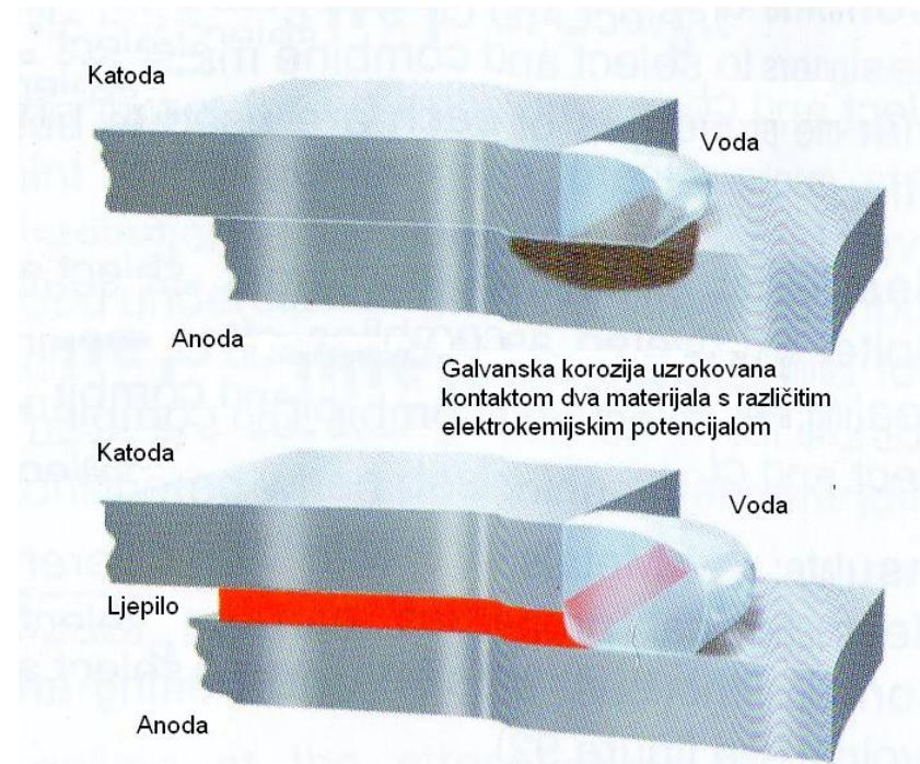
Slika 20. Galvanska korozija kod spojeva [8]
