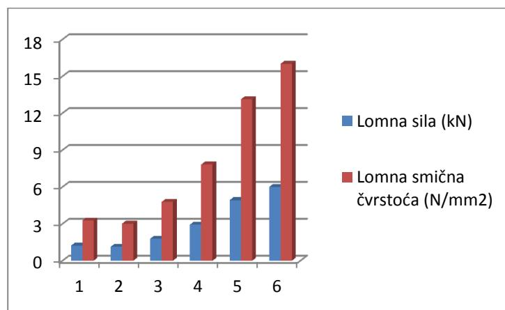
Iz tablice 7 (graf) se jasno vidi da je čvrstoća spoja direktno povezana s pripremom lijepljenih dijelova. Što je priprema lijepljenih dijelova kvalitetnija, to su i čvrstoće lijepljenih spojeva veće.
