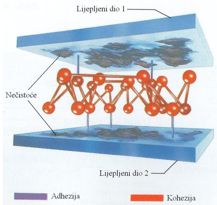
Slika 12. Utjecaj nečistoća na adheziju i čvrstoću spoja [8]
