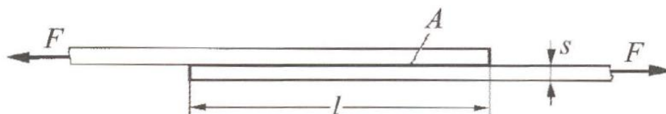
Slika 16. Lijepljeni preklopni spoj limova, A - površina lijepljenog spoja, l - duljina, s - debljina lima [3]
