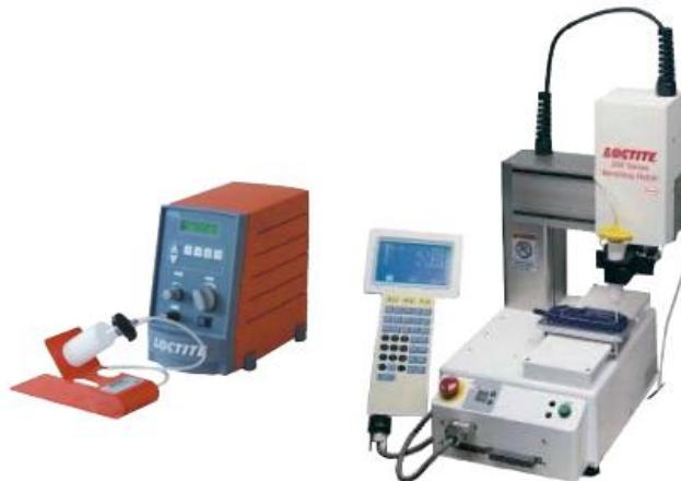
Slika 15. Poluautomatski uređaj i robot za nanašanje ljepila [16]
