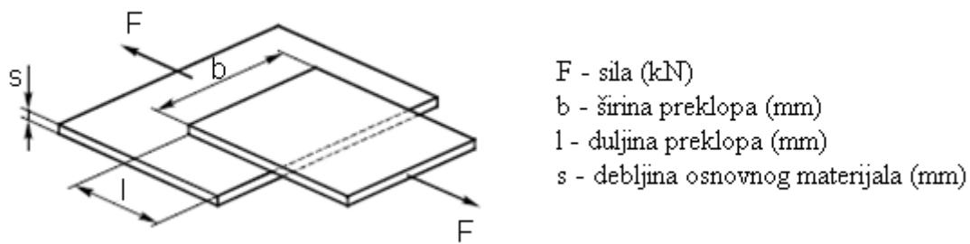
Slika 23. Odnos duljine lijepljenog spoja i debljine osnovnog materijala [4]
