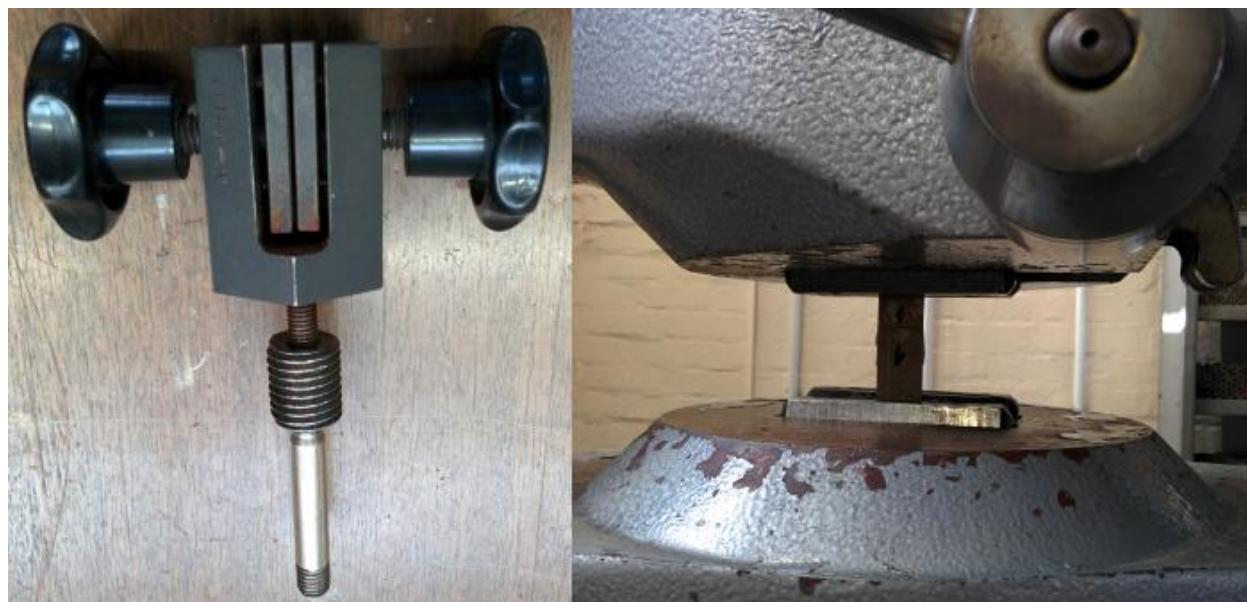
Slika 50. Kliješta za stezanje uzoraka na kidalici
