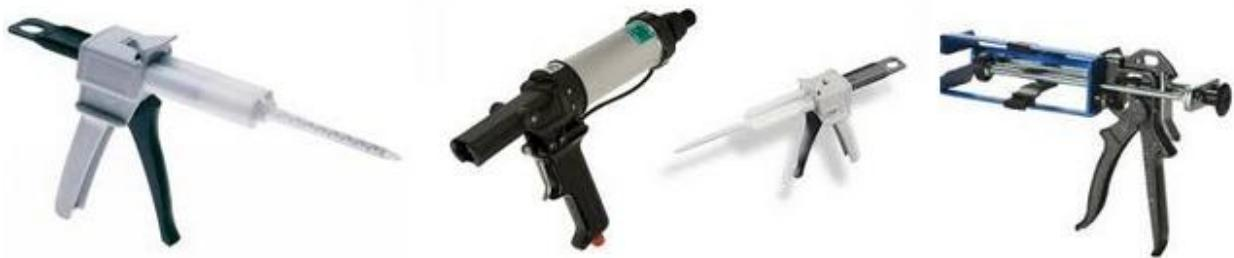
Slika 14. Oprema za ručno nanošenje ljepila [15]
