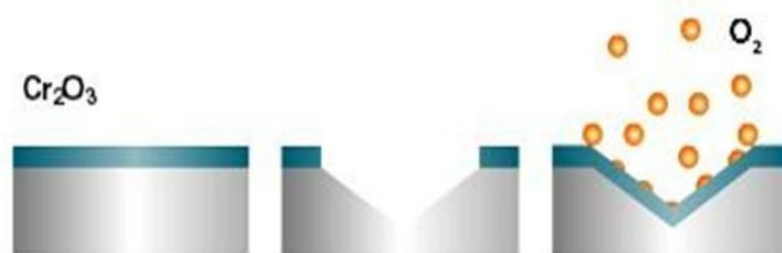
Slika 13. Pasivni sloj na nehrđajućem čeliku [12]
