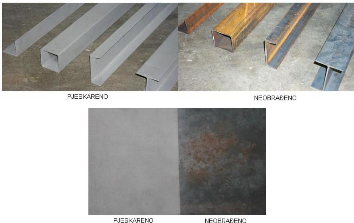
Slika 10. Površine pjeskarenih čelika i neobrađenih čelika [14]
