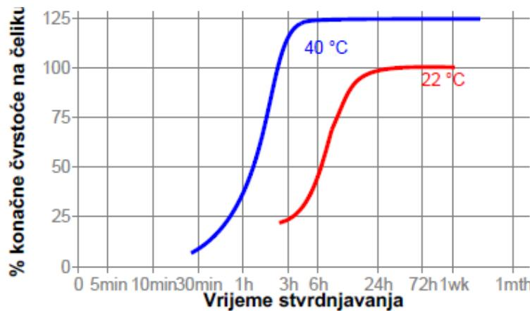
Slika 44. Ovisnost čvrstoće spoja o vremenu stvrdnjavanja [22]
