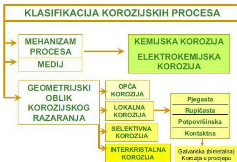
Slika 2. Klasifikacija korozijskih procesa [1]
