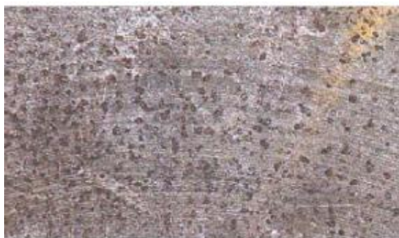
Slika 9. Grafitizacija sivog lijeva [11]
