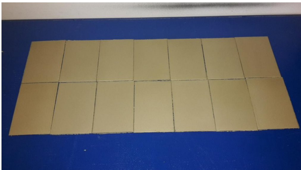
Slika 21. Uzorci sa nanesenom temeljnom bojom
