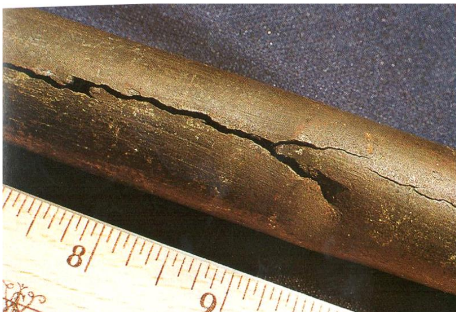
Slika 12. Pukotina uzrokovana napetosnom korozijom [13]
