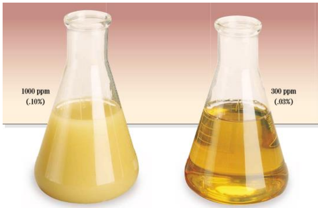
Slika 8. Vizualni efekt vode u ulju [34]
