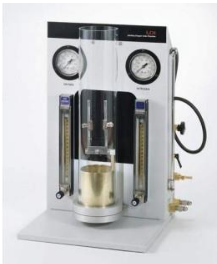
Slika 5. Uređaj za mjerenje indeksa kisika [28]
