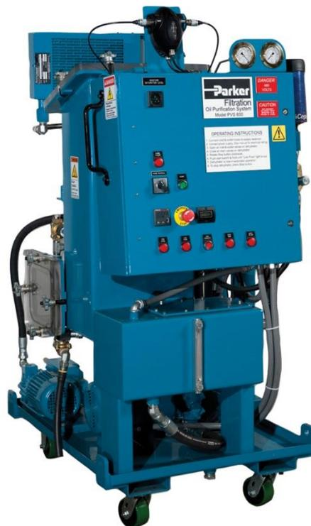
Slika 9. Uredaj za vakuum dehidraciju [35]
