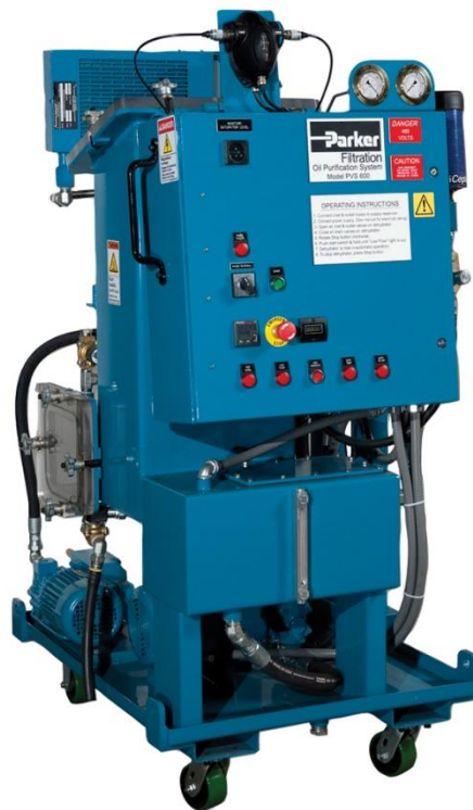
Slika 9. Uredaj za vakuum dehidraciju [35]
