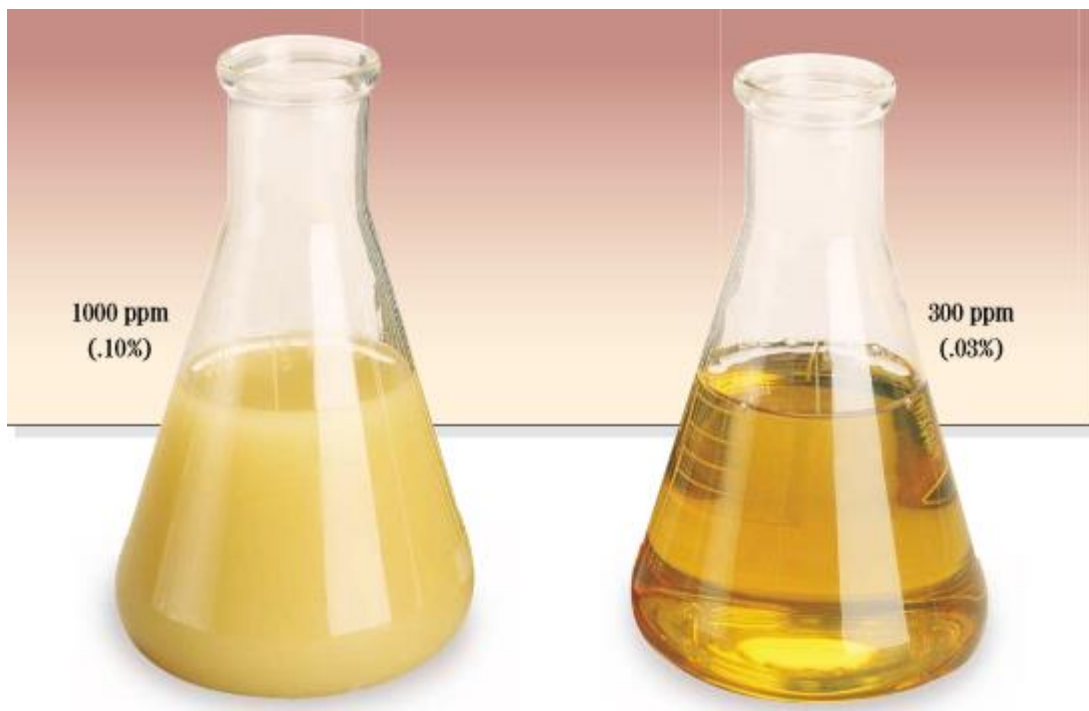
Slika 8. Vizualni efekt vode u ulju [34]
